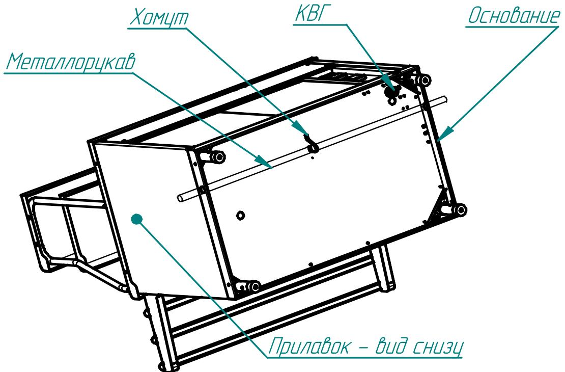
В основаниях изделий линии раздачи введенено сквозное отверстие диаметром 29,5 мм и поддерживающие хомуты для возможности проведения металлического рукава с питательными кабелями сквозь все изделия линии раздачи.
