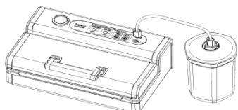
Fissare un'estremità del tubo flessibile per la messa sotto vuoto all'attacco sull'apparecchio e un'estremità all'attacco sul coperchio del contenitore.
