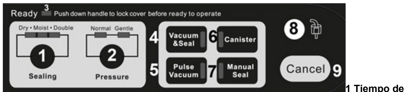
**1 Tiempo de sellado (Sealing):** Hay tres ajustes para seleccionar el tiempo de sellado "seco" (dry), para un producto al vacío seco o sin líquido, con intervalo de sellado corto.
