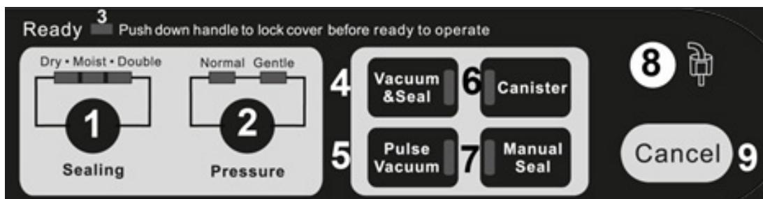
**1 Tempo di saldatura (Sealing):** Sono disponibili tre differenti impostazioni per la selezione del tempo di saldatura
