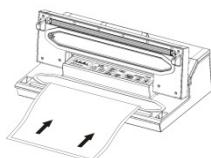
Vérifiez que le bout ouvert du sachet se trouve dans la chambre de dépressurisation pour garantir que l'air ne s'échappe pas. Ne bouchez pas l'entrée d'air.
