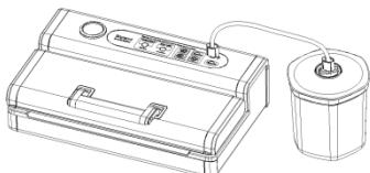
Fije un extremo del tubo flexible de vacío a la conexión del aparato y otro extremo a la conexión de la tapa del recipiente.
