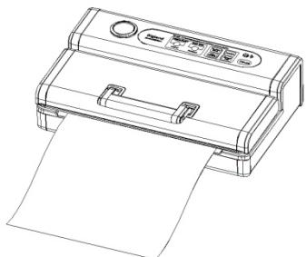
Sluit het deksel en druk deze stevig naar beneden op het handvat, tot u twee klikken hoort. Druk op de kop „handmattig lassen“ (Manual Seal). Het controlelampje "handmatig lassen" (Manual Seal) gaat branden. Het controlelampje gaat uit zodra het sealingproces is beëindigd.
