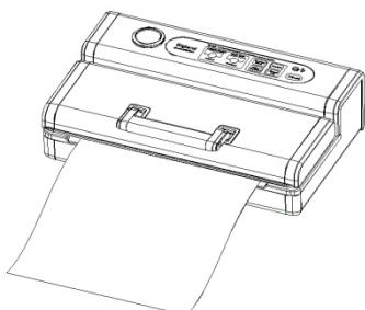
Chiudere il coperchio e premere il manico verso il basso, fino a quando sentite il rumore di due „clic“. Premere il tasto „Saldatura manuale“ (Manual Seal). Si accende la spia di segnalazione „Saldatura manuale“ (Manual Seal). La spia di segnalazione si spegne quando il processo di sigillatura è concluso.
