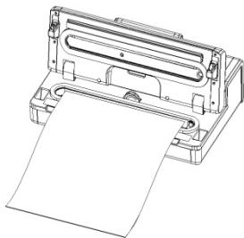
Vergewissern Sie sich, dass sich das offene Ende des Beutels innerhalb der Vakuumkammer befindet. Dies garantiert, dass kein Vakuum entweicht. Verdecken Sie nicht den Lufteinlass. Schließen Sie den Deckel und drücken Sie den Griff fest herab. Überprüfen Sie die LED-Zustands-Anzeigen und wählen Sie die von Ihnen gewünschte Versiegelungszeit und Vakuumstärke aus.
