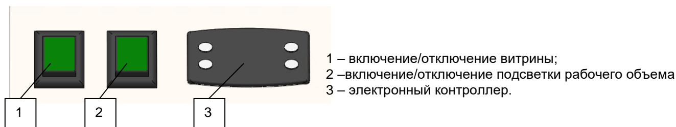
Рисунок 3. Внешний вид панели управления и назначение кнопок.
