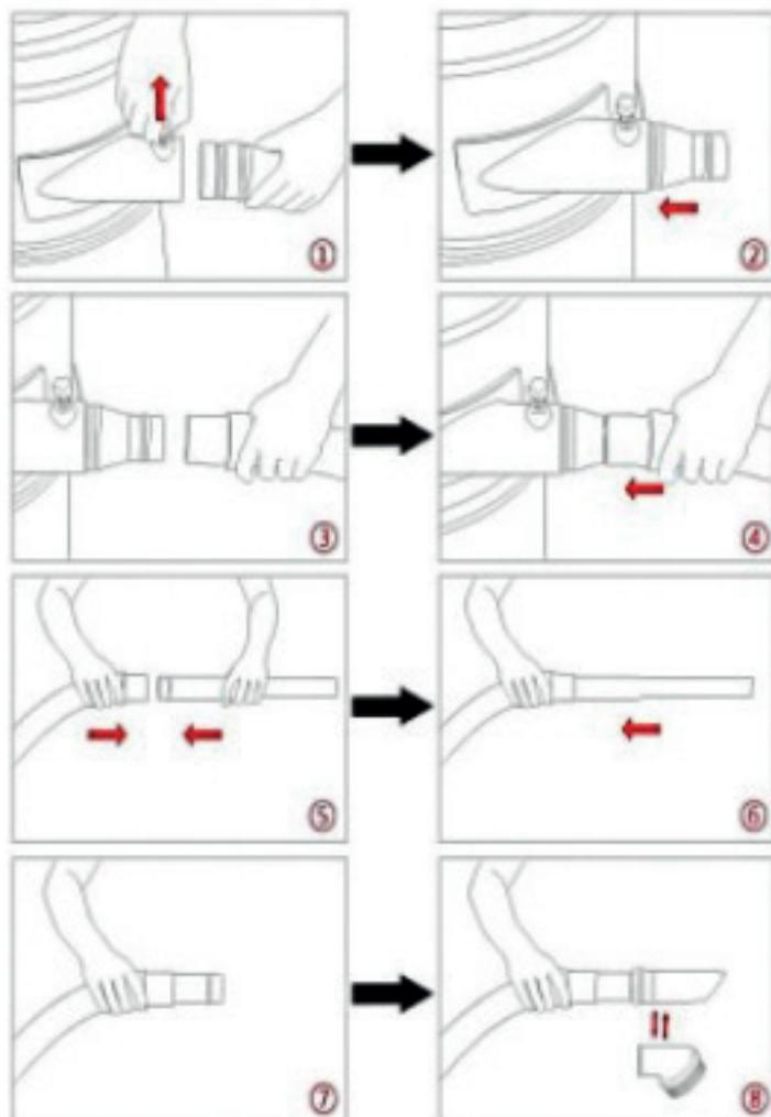
Шаг1: Поднимите пряжку, затем вставьте непосредственно в соединение из алюминиевого сплава и опустите пряжку, чтобы завершить соединение.
