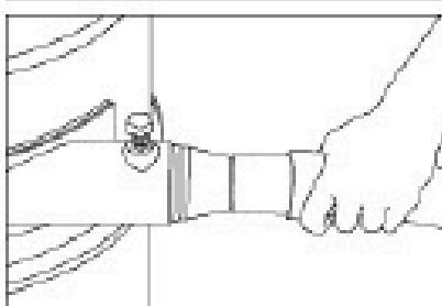
2. Вставьте шланг в соединитель, а затем поверните по часовой стрелке, чтобы завершить фиксацию.
