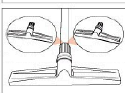
4. Соедините удлинительную трубу вместе, затем подсоедините один конец к соединителю шланга, а другой - к щетке для сбора пыли/влаги.
