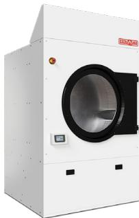
Машины сушильные предназначены для сушки белья из смешанных и хлопчатобумажных тканей, отжатых до 50% влажности. Сушильные машины выпускаются в полной комплектации: с автоматическим управлением, реверсивным вращением барабана, предотвращающим скручивание белья; сигнализацией засорения фильтра, датчиком остаточной влажности и режимом продувки холодным воздухом (Cool Down).
