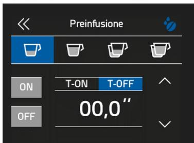
Войдя в настройки предварительной инфузии, можно установить время включения и выключения электромагнитного клапана группы для каждой отдельной дозы и настроить таким образом требуемую предварительную инфузию.
