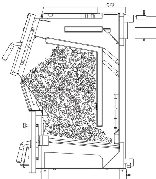
**Рис.10** Схема загрузки котла углем
