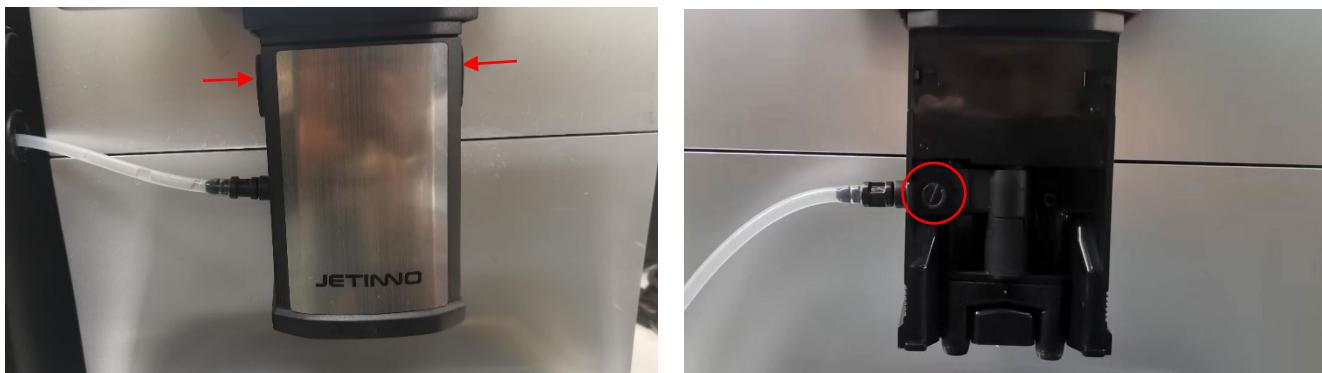
Нажмите и удерживайте защелки с обеих сторон раздаточной группы и снимите крышку раздаточной группы так, чтобы вы могли видеть регулировочную ручку, поверните ее вручную по часовой стрелке, и температура теплого молока и пены увеличится, и поверните ее против часовой стрелки, чтобы уменьшить. Рекомендуется выполнить точную настройку и не регулировать величину слишком сильно.
