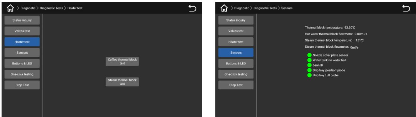
Диагностический тест — тест нагревателя: здесь пользователи могут проверить все бойлеры в машине; Диагностический тест — Датчик: Здесь пользователь может проверить все датчики внутри машины.
