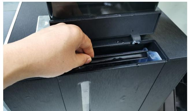
Откройте крышку бака, поднимите бак вверх, наполните бак чистой водой и загрузите бак обратно в машину. Определяется уровень воды в резервуаре, и отображается запрос на интерфейс нехватки воды.
