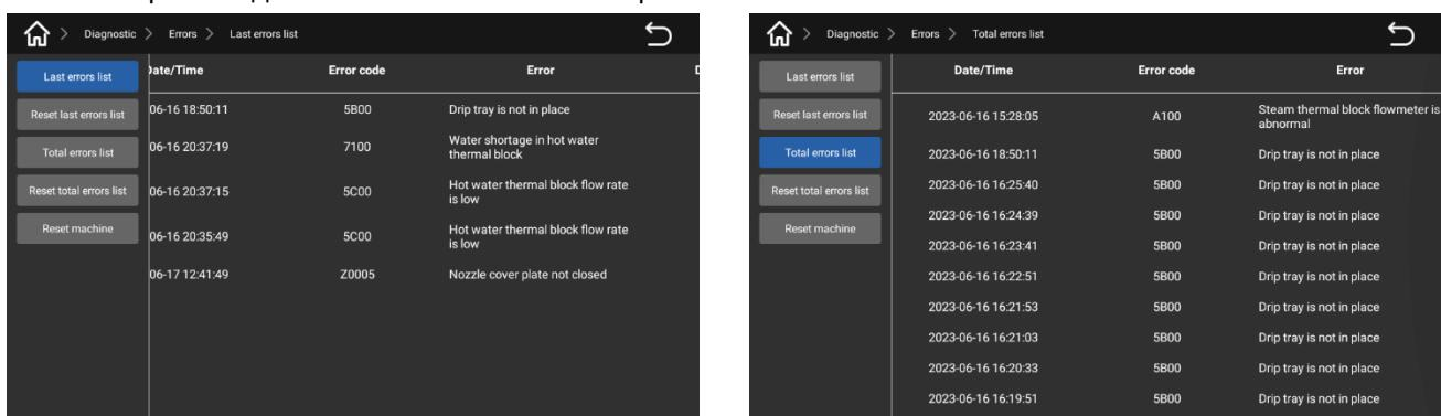
Неисправности — список текущих неисправностей: пользователи могут запросить текущие неисправности; Неисправность — общий список неисправностей: пользователи могут запросить
