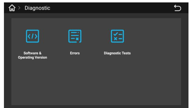
Войдите в техническое меню кофемашины и нажмите «Диагностика», диагностические функции включают в себя «версию программного обеспечения и операционной системы, неисправность, диагностический тест».
