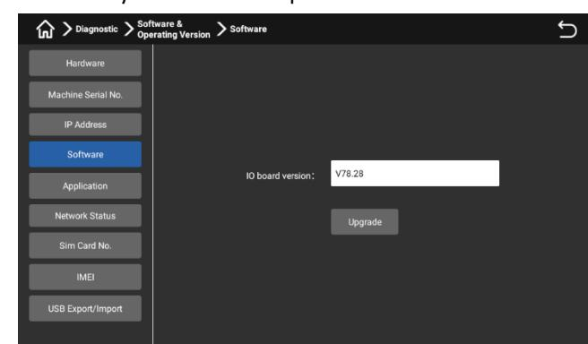
Версия программного обеспечения и операционной системы - IP-адрес: здесь пользователи могут включать/выключать автономный режим и устанавливать IP-адрес; Версия программного обеспечения и эксплуатации — Программное обеспечение: пользователи могут проверить и обновить версию встроенного ПО платы ввода-вывода здесь.
