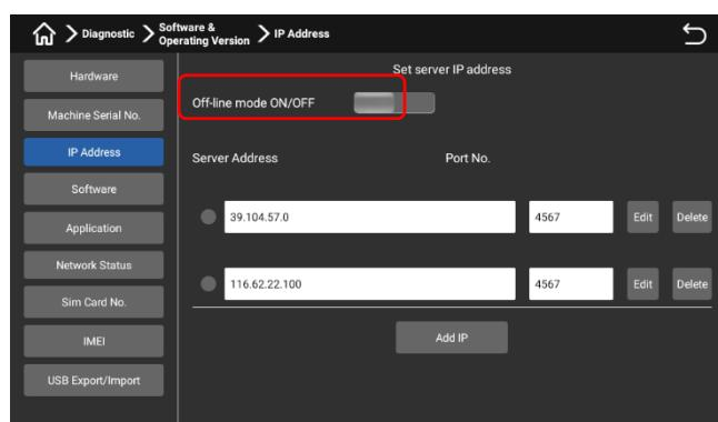
Нажмите «Программное обеспечение и операционная версия» -> «IP-адрес», чтобы отключить автономный режим. Нажмите кнопку «Назад» в правом верхнем углу экрана, чтобы вернуться к интерфейсу верхнего уровня.
