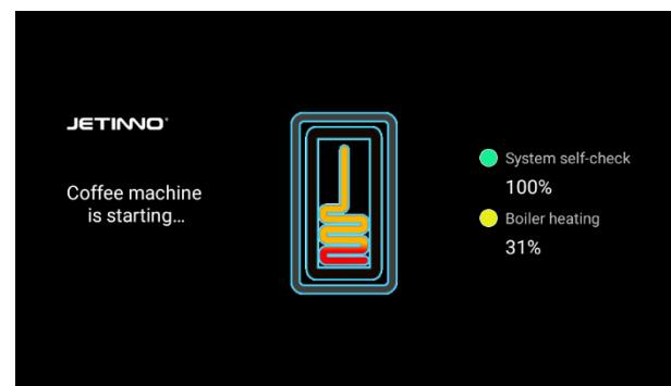
Машина запускается, отображает основной интерфейс и начинает нагрев. Когда желаемая температура будет достигнута, машина будет готова к работе.
