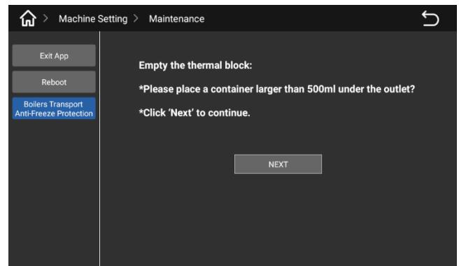
Сначала нажмите кнопку «Защита от замерзания при транспортировке бойлера» в интерфейсе, следуйте инструкциям интерфейса, чтобы начать работу (опорожните бак или отключите внешний источник воды), а затем нажмите «Далее», чтобы открыть следующий интерфейс.
