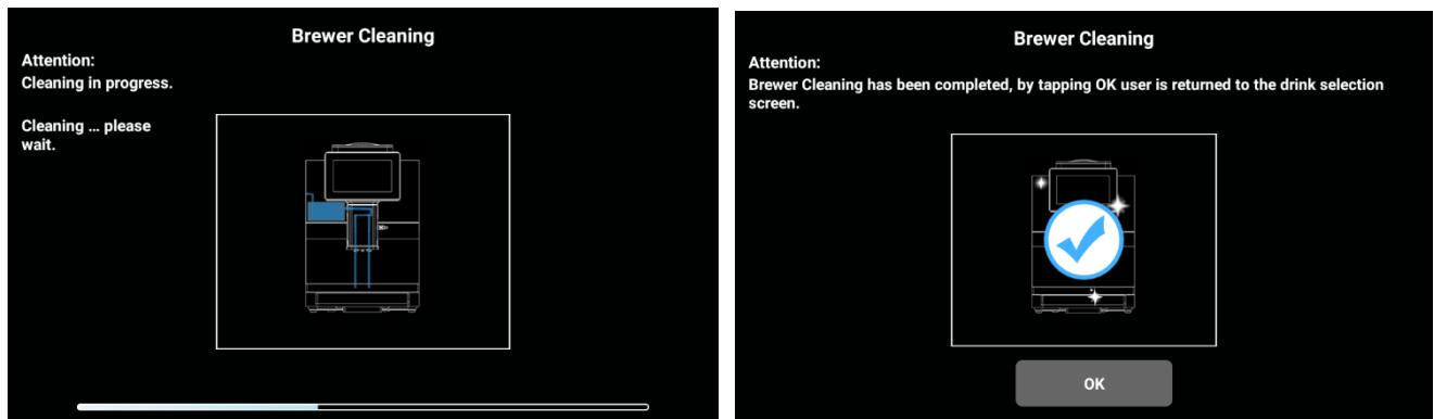
Машина выполняет процедуры очистки кофегруппы. Время очистки кофегруппы занимает около 15 минут, дождитесь завершения программы, интерфейс подскажет: «Очистка заварочного устройства ES завершена, нажмите OK, чтобы вернуть пользователя к экрану выбора напитка»; Нажмите «OK», чтобы вернуться к экрану напитков.
