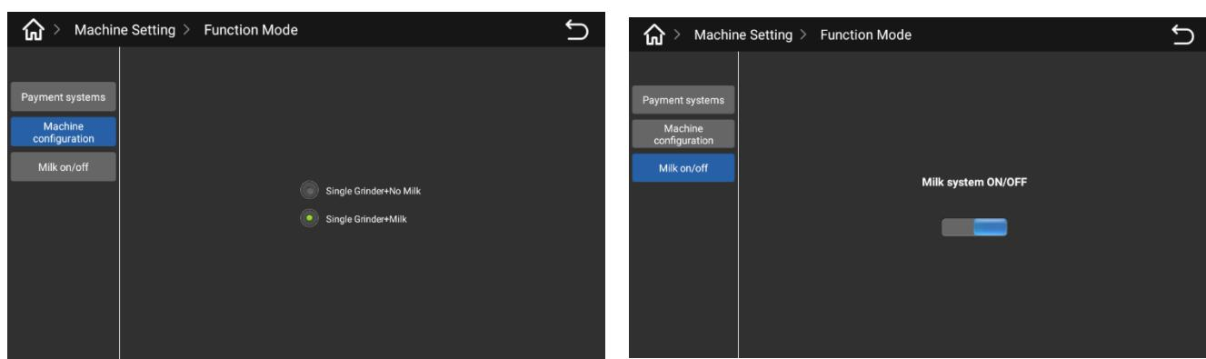
Выберите соответствующую модель машины во всплывающем интерфейсе; В модели со свежим молоком нажмите «Функция свежего молока вкл./выкл.», чтобы открыть кнопку во всплывающем интерфейсе.
