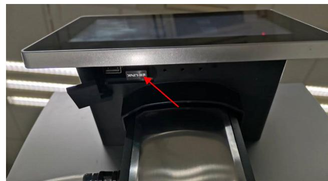
Возмите приемник WiFi сигнала. Откройте kleевую заглушку под дисплеем, вставьте приемник сигнала в USB-порт справа, и машина автоматически перезагрузится. Когда машина перезагрузится, нажмите и удерживайте верхний левый угол экрана, введите пароль: jn9527 во всплывающем диалоговом окне и нажмите «OK».
