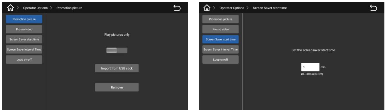
Включите переключатель «Активация рекламы», запишите картинку на USB диск, вставьте USB диск в USB порт на кофемашине (слева, на рамке дисплея), импортируйте картинку с USB диска; установите время начала проигрывания от 0 до 30 минут.
