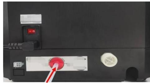
Откройте ручку переключателя между бутилированной водой и встроенным резервуаром -> Стрелка указывает на бутилированную воду, выньте белую трубку из машины и вставьте трубку в разъем до тех пор, пока она не встанет до дна. Другой конец опустите в канистру с водой.
