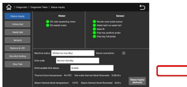
Нажмите «Диагностический тест» -> «Запрос состояния», чтобы просмотреть: ● Конфигурацию подключения к службе; Статус подключения сервиса, указывающий на успешное подключение к серверу; Статус подключения сервиса: ● не удалось подключиться к серверу; Если сервер не удается подключиться, обратитесь к местному оператору связи или агенту, чтобы проверить, зарегистрирован ли сервер.
