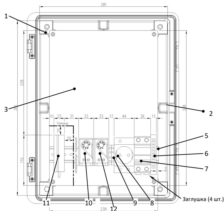
Рисунок 1 – Устройство шкафа
