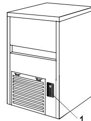
Если прибор постоянно подключен к электросети, включите его, используя переключатель с наружной стороны прибора, установленный на этапе сборки.
