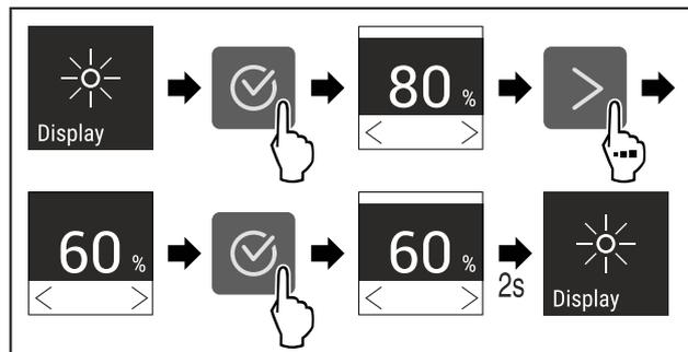
Fig. 128 Примерное изображение: переключение с 80 % на 60 %.
