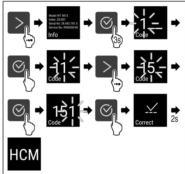
*Fig. 8 Доступ при помощи числового кода 151*
