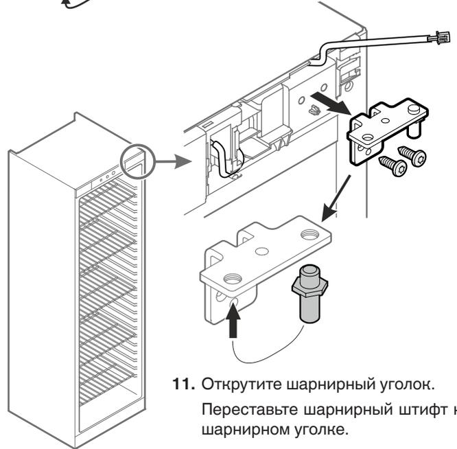
11. Открутите шарнирный уголок. Переставьте шарнирный штифт на шарнирном уголке.
