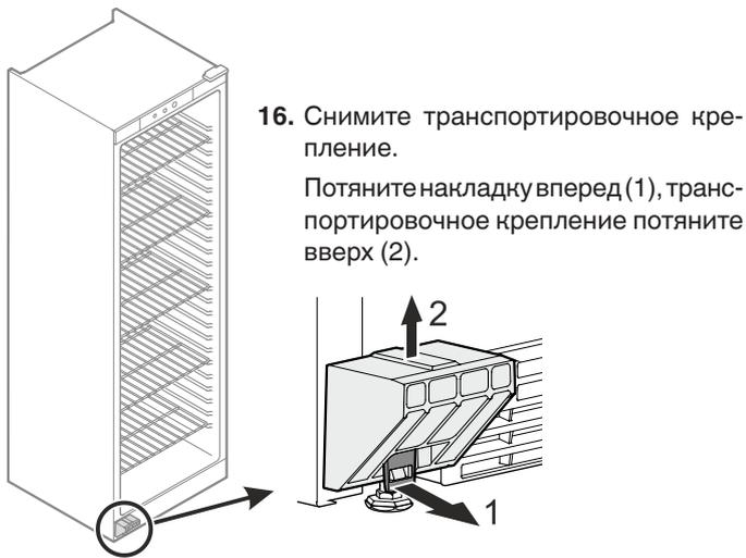
16. Снимите транспортировочное крепление.
