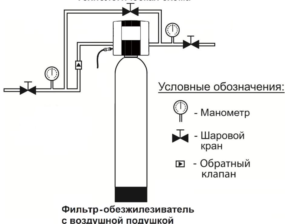
Табл.2 Системы SpaceAqua серии IronOXY V1EWDM с воздушной подушкой
