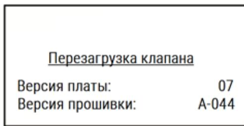
В момент определения типа фильтра панель управления не функционирует. После определения клапан перейдет в режим ожидания. При отсутствии нажатия кнопок в течение 8 минут (по умолчанию) дисплей тускнеет, активировать дисплей возможно нажатием любой кнопки.
