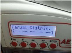
Нажатие каждой кнопки осуществляет выброс монеты из соответствующей тубы Для выхода одновременно нажмите Esc и Enter, а потом многократно Esc
