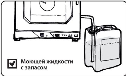
2. Убедитесь, что дверь печи плотно закрыта, а сливная труба не имеет препятствий.
