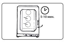
7. Отключите режим пара, выключите нагрев, откройте дверь и тщательно промойте душем.
