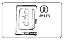
Смочите поверхность камеры с помощью душа или включите режим пара (100%) и установите температуру 50-55С°С на 10-15 минут.
