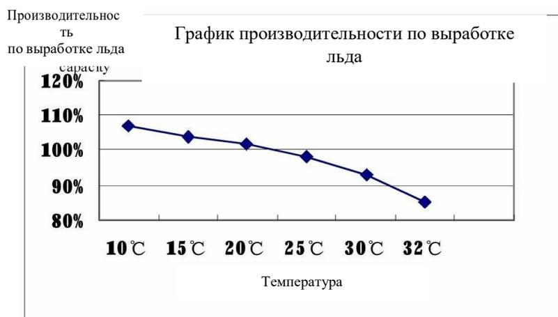
Примечание: В данном графике отображены фактическая производительность по выработке льда для воды 15 °С; в то время, как температуры воды увеличивается, производительность по выработке льда снижается.
