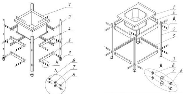
1. На ноги (поз. 2) установить регулируемые опоры (поз. 3);
