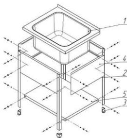
1. На ноги (поз. 2) установить регулируемые опоры (поз. 3);
