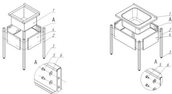
1. На ноги (поз. 2) установить регулируемые опоры (поз. 3);
