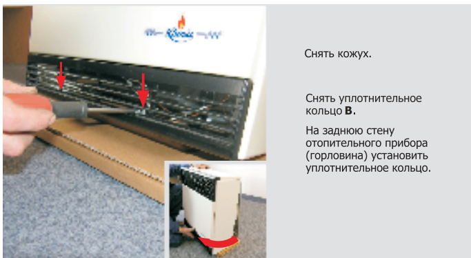
13 МОНТАЖ КАМЕРЫ ГОРЕНИЯ
