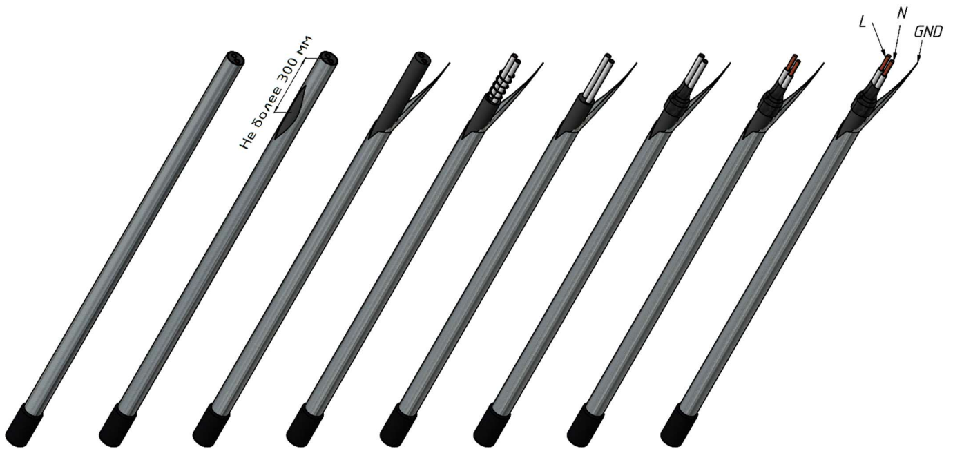
Рисунок 15. Подготовка отрезка ПЭНа к подключению
