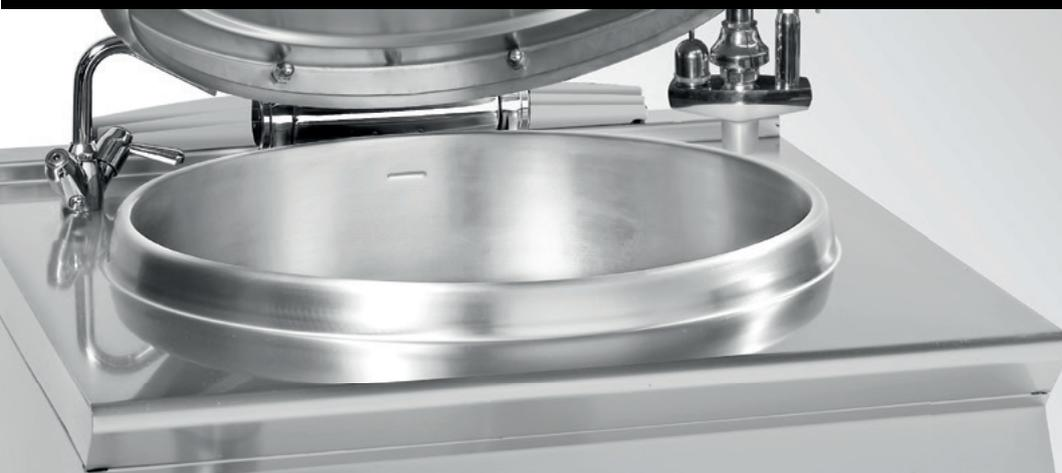
**IT** | Le pentole della gamma Unika sono disponibili nelle versioni a riscaldamento diretto o indiretto. Nelle versioni indirette, il controllo della pressione dell'intercapedine avviene tramite valvola di sicurezza e manometro analogico. Il riempimento della vasca è effettuato tramite rubinetto a snodo, mentre lo scarico è consentito da un rubinetto in ottone cromato con maniglione. Il sistema autoclave (0,05 bar) è disponibile su richiesta.
