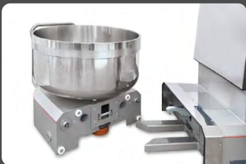
Захват дежи при помощи гидравлического крюка, автоматизированный благодаря инновационной системе сцепления
