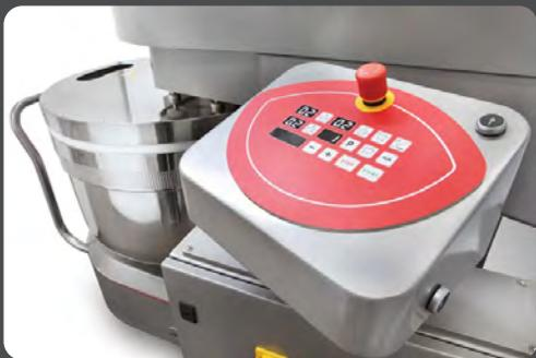
Электрический блок и панель управления расположены на боковой стороне машины и всегда легкодоступны для оператора
