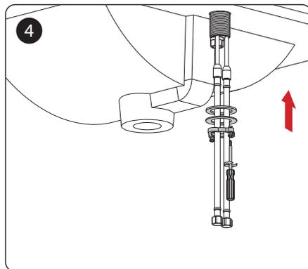
4 Снизу раковины наденьте резиновую шайбу, металлическую шайбу и монтажный кронштейн на резьбовой стержень. При необходимости отрегулируйте положение корпуса крана, затем затяните крепежные гайки крестообразной отверткой до упора.
