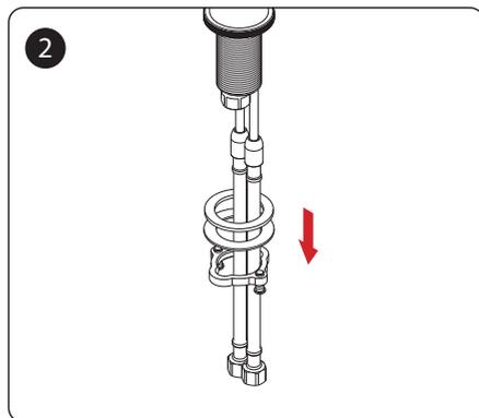
2 Снимите крепежные детали.
