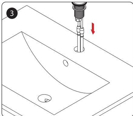
3 Установите уплотнительное кольцо к основанию смесителя. По очереди опустите шланги для подачи воды в монтажное отверстие. Затем вставьте кран в отверстие.
