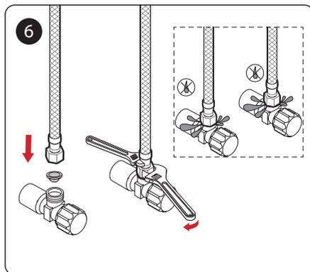
Соедините подводку с водопроводными трубами. Убедитесь, что подача горячей воды – слева, а холодной – справа. Включите воду и проверьте соединения на герметичность. Проверьте работу смесителя.
