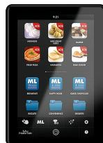
Цветной емкостной ЖК-дисплей высокого разрешения с диагональю 7", с сенсорным выбором функций. Дисплей настраивается в зависимости от потребностей пользователя, вынося на первый план наиболее часто используемые рецепты.
