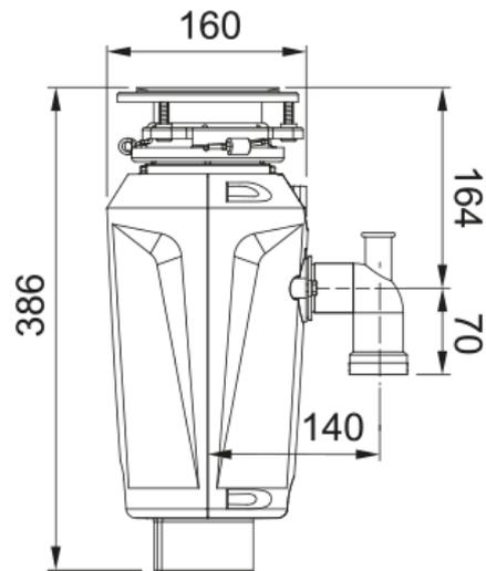
Измельчитель пищевых отходов с пневматическим выключателем, количество оборотов: 2800 об/мин, объем камеры: 0,86 л, 386x160 мм
