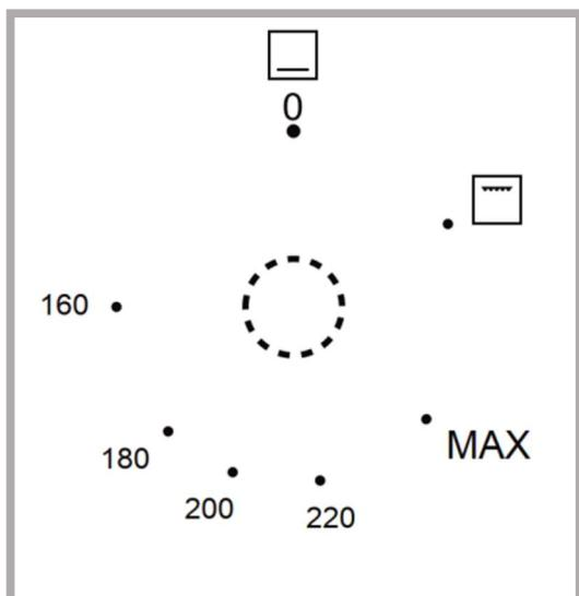
Данный регулятор позволяет включать подачу газа и настраивать интенсивность газового нагрева (поворот рукоятки против часовой стрелки), а также включать функцию электрического гриля (поворот рукоятки на одну позицию по часовой стрелке). Обратите внимание, что при работе электрического гриля подача газа во внутреннюю камеру не осуществляется, а при работе газового нагрева электрический гриль всегда выключен.
