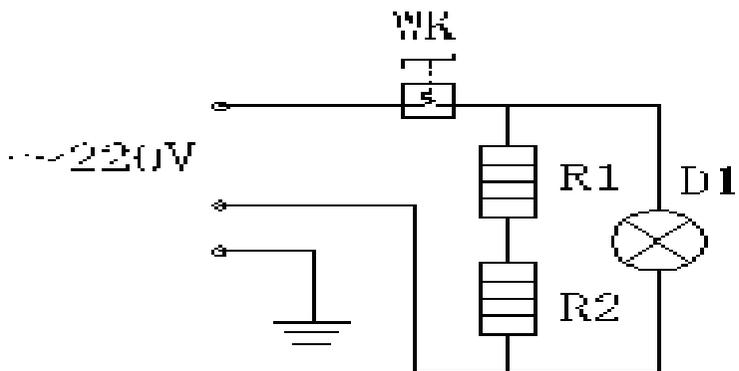
R1, R2 — нагревательный элемент D — индикатор нагрева WK1 — термостат
