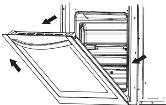
Возьмите дверь обеими руками с двух сторон. Немного поднимите дверь и снимите петли с обеих позиций. Потяните дверь к себе, чтобы снять петли с отверстий рамки двери.
