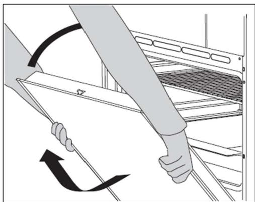
Для установки дверцы выполните описанные действия в обратном порядке. держа дверь по бокам обеими руками ближе к нижней части двери, установите петли в отверстия передней рамки духового шкафа. Полностью открыв дверь, снимите два металлических стержня с петель. Медленно закройте дверь. Убедитесь, что она установлена правильно и ровно относительно боковых сторон.
