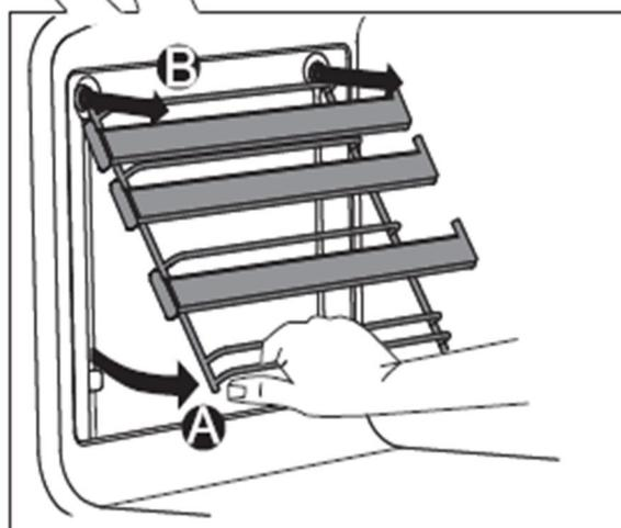
**A.** Приподнимите направляющие снизу, отведя их от стенки.
