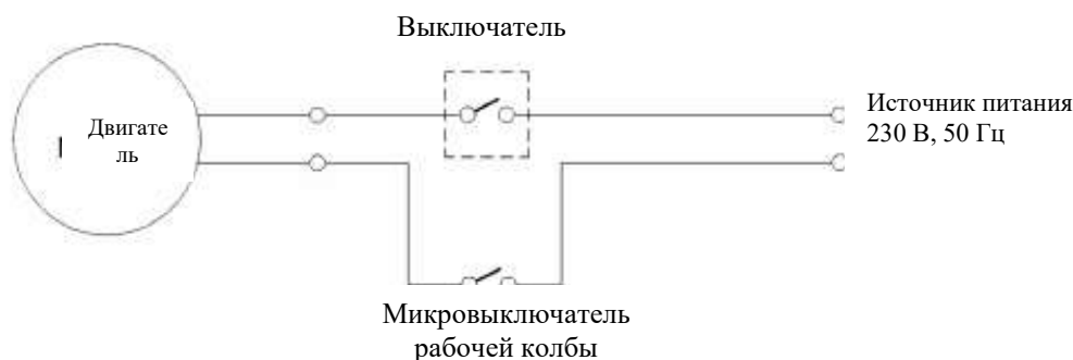
Иллюстрация 6. Схема однофазных электрических соединений на 230 В.
