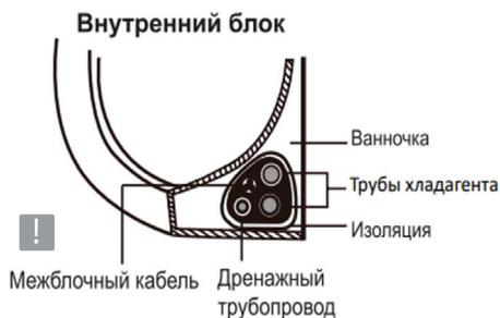
Специальной изоляционной или войлочной лентой свяжите вместе трубы хладагента, межблочный кабель и дренажный шланг как показано на рисунке ниже. Расположите дренажный шланг под трубопроводом хладагента (размещение дренажного шланга в верхней части связки может привести к переливу дренажного поддона и, как следствие, к заливу помещения водой)
