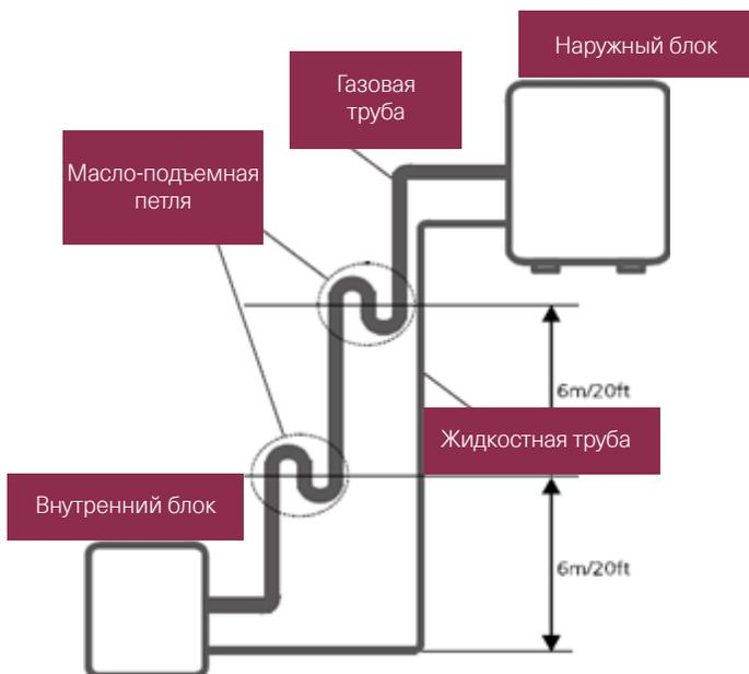
Подключение трубопроводов к наружному блоку проводится с теми же операциями по резке, зачистке и вальцовке трубы к внутреннему блоку.
