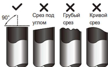
Тщательно удалите все заусенцы со среза трубы. Во время удаления заусенцев держите трубу срезом вниз, чтобы стружки и пыль не попали внутрь неё.
