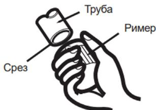
Установите комплектные гайки на трубки, с которых уже удалены заусенцы. Гайки должны быть расположены в правильном направлении. После развальцовки труб установить гайки уже нельзя!
