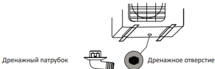
В режиме обогрева наружный блок выделяет конденсат. Выберите место установки так, чтобы кондиционер и земля под ним не смачивались конденсатом, чтобы не было риска повреждения прибора при замерзании воды.
