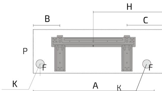
Подключение трубопровода хладагента выполняется после окончания установки внутреннего блока кондиционера. При выборе места установки учитывайте расположение труб холодильного контура, дренажного шланга, проводов, соединяющих внутренний блок с линией питания и наружным блоком. Трубопроводы могут быть подведены в точках 1, 2, 3, 4 и 5, как показано на рисунке ниже. Если трубопроводы подведены в точках 3, 4 и 5, необходимо обеспечить соответствующий паз в панели внутреннего блока.
