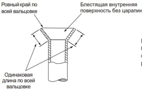
Развальцуйте трубу с помощью вальцовок. Снимите вальцовку и форму для вальцовки, осмотрите кромку трубы на предмет трещин и равномерной вальцовки.
