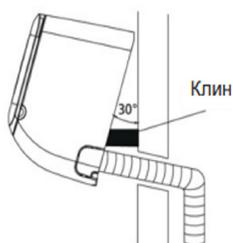
С помощью подпорки или клина подоприте блок, чтобы беспрепятственно выполнить присоединение фреонопровода, межблочного кабеля и дренажного шланга.
