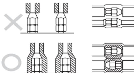
Специальной изоляционной или войлочной лентой свяжите вместе трубы хладагента, межблочный кабель и дренажный шланг как показано на рисунке ниже. Расположите дренажный шланг под трубопроводом хладагента (размещение дренажного шланга в верхней части связки может привести к переливу дренажного поддона и, как следствие, к заливу помещения водой)
