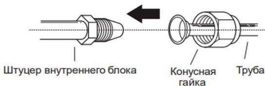
Используя динамометрический ключ, затяните конусную гайку. При затяжке ориентируйтесь на значения, приведенные ниже в таблице. Чрезмерная затяжка может повредить развальцованный участок.
