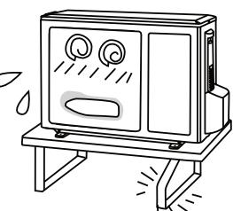
Ненадежно установленный блок может привести к его поломке или нанесению травмы.
