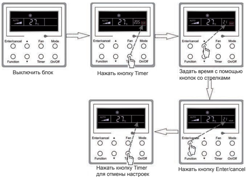
Рис. 8. Последовательность настройки таймера
