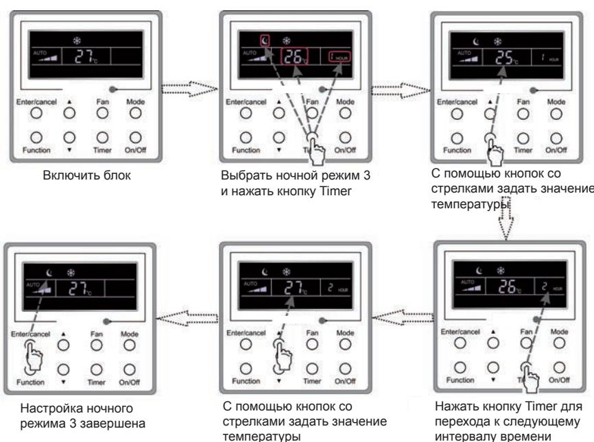
Рис. 13. Настройка графика изменения температуры в ночном режиме 3
