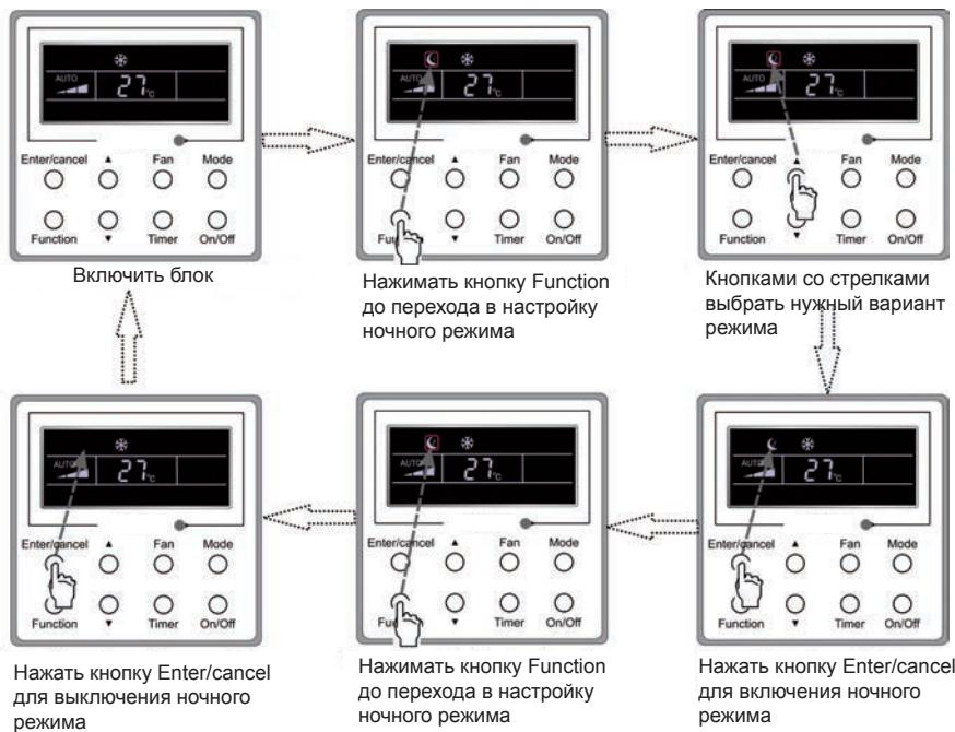
Рис. 10. Последовательность включения и выключения
