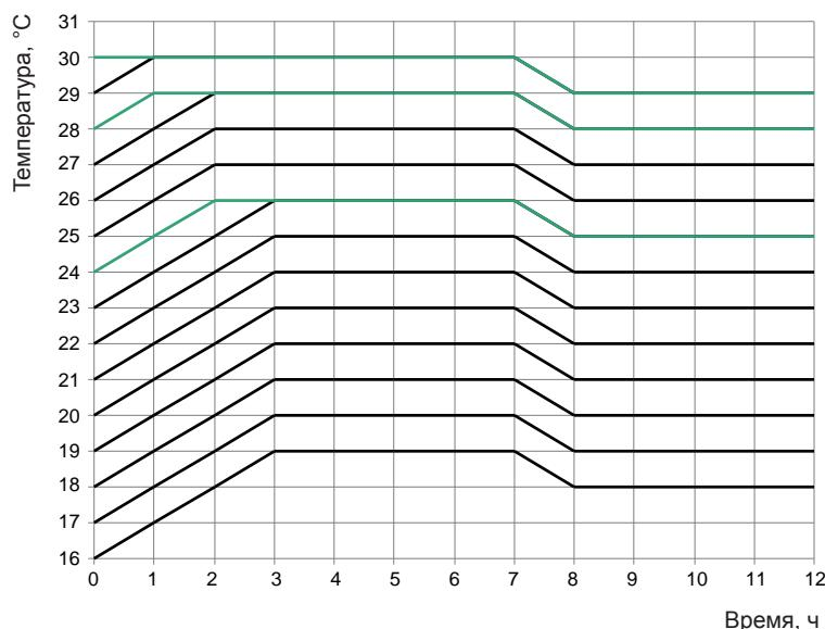
Рис.11. График изменения температуры в ночном режиме 2
