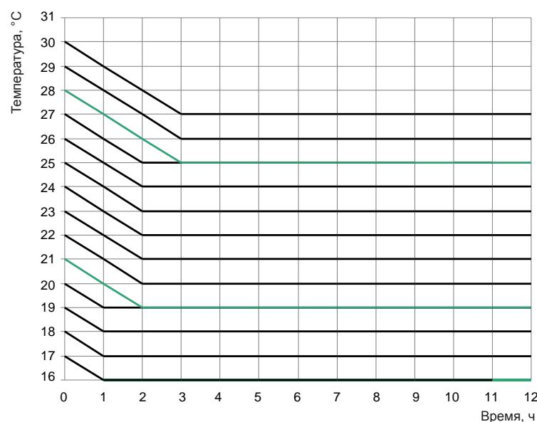
Рис.12. График изменения температуры в ночном режиме 2
