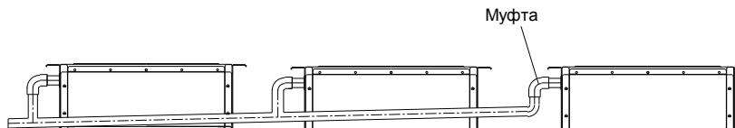
Параметры соединений дренажной трубы должны соответствовать производительности блока.
