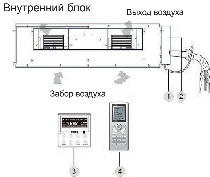
1 — кабель питания; 2 — электрическая коробка; 3 — проводной пульт управления; 4 — беспроводной пульт управления;
