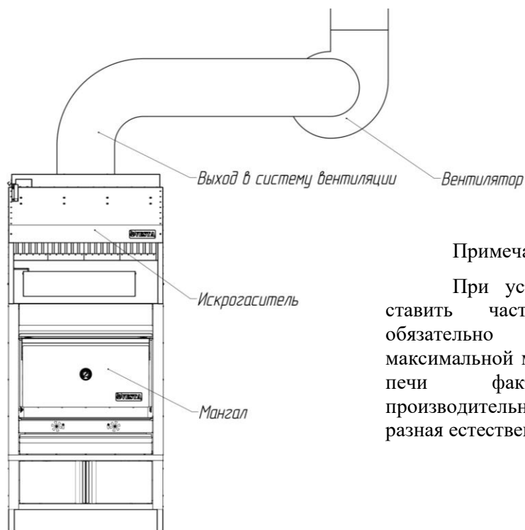
Рисунок 7 – Схема подключения мангала к вентиляции
