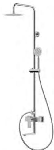
Выдвижная телескопическая стойка (нерж. сталь, покрытие хром): высота стойки 1172 мм, диаметр 25 мм, вылет верхнего душа 360 мм, высота функциональная 1049 мм, держатель лейки плавающий FightFix. Лейка верхнего душа (ABSпластик): на подвижном шарнире. Ручная лейка: с 1 режимом. Смеситель латунный с поворотным изливом: керамический картридж и дивертор, поворотный излив с вылетом 198 мм. Комплектация: душевой шланг 150 см (в армированной ПВХ оплетке), монтажный комплект
