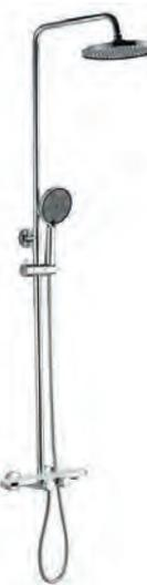
Верхняя лейка снимается для очистки. Душевая стойка из нержавеющей стали. Регулируемая высота штанги 850-1540мм. Система SelfClean позволяет легко очистить форсунки от известкового налета. Встроенная технология EcoSystem обеспечивает минимальный расход воды. Увеличенная ручная лейка 125мм с тремя режимами позволит выбрать наиболее подходящий вариант использования. Шланг в металлической оплетке со стандартной резьбой 1/2".
