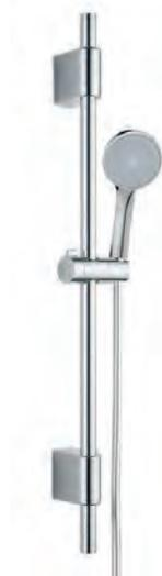
Высота стойки 650 мм, диаметр 22 мм, регулировка крепления по высоте. Ручная лейка АВС-пластик, 1 режим, диаметр 111 мм. Шланг 1,5 м силиконовый.
