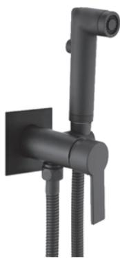
Покрытие "черный матовый" В набор входит: Смеситель скрытого монтажа: корпус - латунь кат. А, картридж ESKO- 25мм. , отражатель (металл) и монтажный комплект Гиг. лейка: 1 режим, материал - ABS пластик, Есо system Держатель: вертикальный, материал - латунь Душевой шланг: 120см в металл. оплетке, усиленный
