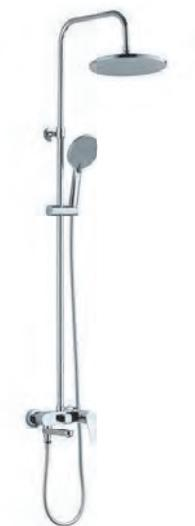
Телескопическая стойка(нерж. сталь, хром): высота функциональная 1050 -1500мм , диаметр 22мм ,вылет верхнего душа 340мм ,держатель ручной лейки плавающий FightFix. Лейка верхнего душа(ABS): диаметр 300мм. Ручная лейка: диаметр 120мм, 3 режима. Смеситель с поворотным изливом: картридж 35мм , встроенный в излив переключатель, вылет излива 140мм Комплектация: душевой шланг 150см, монтажный комплект
