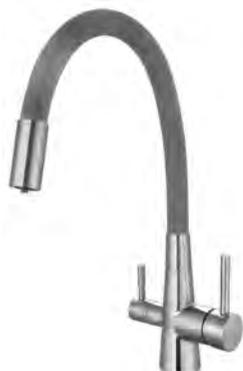
Корпус: нерж.сталь SUS 304, канал для фильтрованной воды с отдельным аэратором и ручкой включения Излив: гибкий, метал. каркас, EPDM резина. Картридж: универсальный ESKO, 35мм
