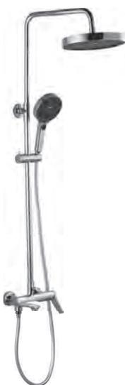
Выдвижная телескопическая стойка(нерж. сталь в хrome): высота функциональная 890 -1580мм, вылет верхнего душа 380мм , Лейка верхнего душа(ABS) :диаметр 255мм, Ручная лейка: диаметр 130мм, 3 режима,переключатель - кнопка, Смеситель с поворотным изливом: картридж 35мм , переключатель отдельный двухканальный (ручной душ - верхний душ), выдвижной излив служит дивертором. Вылет излива 160мм, наклон аэратора 4 гр. Комплектация: душевой шланг 150см (в металл. оплетке), монтажный комплект
