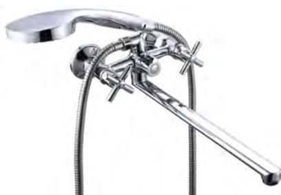
Корпус: латунь кат.А; Ручки: металл, с защитой от нагревания; Излив: поворотный, 350мм. Кран-буксы: универсальные ESKO, ход 180 градусов. Переключатель: механический(керамика).
