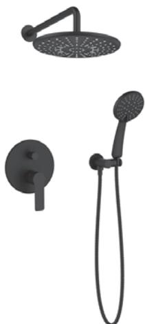
Корпус смесителя - латунь кат. А, картридж ESKO - 35мм, переключатель механический, "IBOX" для монтажа. Лейка верхнего душа: диаметр 230мм, материал - ABS. Держатель верхнего душа с отводом: вылет 352мм, нерж.сталь, кронштейн крепления и Ручная лейка: диаметр 106мм, 5 режимов. Держатель ручного душа: вертикальный с поворотным держателем, материал - латунь. Излив: вылет 11,3см, нерж. сталь
