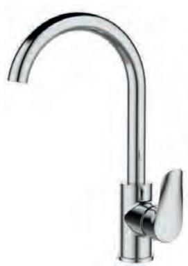
Корпус: латунь кат.А Излив: поворотный, нерж.сталь Картридж: универсальный ESKO,35м Комплектация: крепление "FastFix",гибкая подводка 45см.
