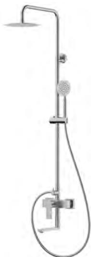
Выдвижная телескопическая стойка(нерж. сталь, покрытием хром): высота стойки 1172мм, диаметр 25мм ,вылет верхнего душа 360мм , высота функциональная 1049мм, держатель лейки плавающий FightFix Лейка верхнего душа(ABS-пластик) : на подвижном шарнире. Ручная лейка: с 1 режим, Смеситель латунный с поворотным изливом: керамический картридж и дивертор, поворотный излив с вылетом 198мм Комплектация: душевой шланг 150см (в армированной ПВХ. оплетке) , монтажный комплект
