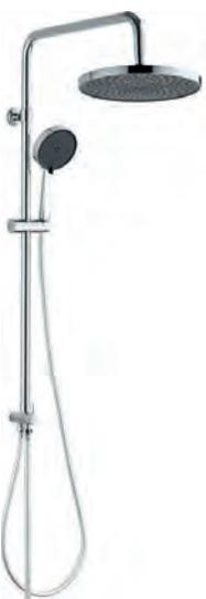
Цельная стойка(нерж. сталь, хром): высота 955мм , диаметр 25мм ,вылет верхнего душа 500мм, подвижное крепление Free Mount. Лейка верхнего душа(нерж. сталь, хром): на подвижном шарнире, диаметр 240мм. Ручная лейка: 3 режима. Переключатель с ручного на верхний душ: керамическая кран-букса. Комплектация: душевой шланг 150см и шланг для подкл. к смесителю (армированный ПВХ, серебристый, Free Rotation), монтажный комплект
