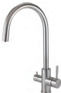
Корпус: нержавеющая сталь, марка SUS 304 (пищевая сталь), аэратор с каналом для фильтрованной воды Излив: поворотный, нерж. сталь Картридж: универсальный ESKO, 35мм Комплектация: пьедестал(металл),ребро жесткости, крепление "FastFix",гибкая подводка 45см, шланг подключения к фильтру.
