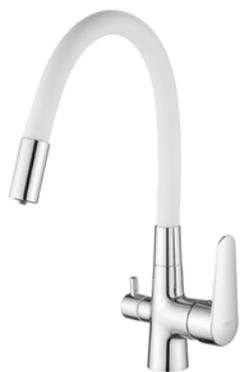
Корпус: латунь кат.А (покрытие - хром), канал для фильтрованной воды с отдельным аэратором и ручкой включения Излив: гибкий, метал. каркас, EPDM резина. Картридж: универсальный ESKO, 35мм
