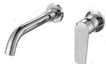
Смеситель скрытого монтажа для умывальника: корпус - латунь кат.А, излив - нерж.сталь, покрытие: хром, картридж универсальный ESKO- 35мм, латунный скрытый единый корпус, отражатель и монтажный комплект
