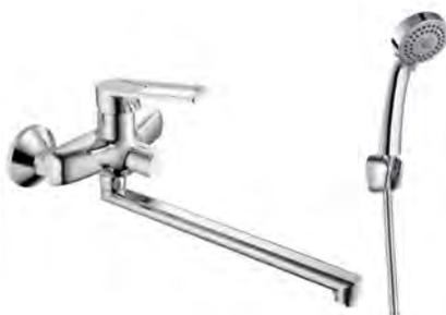
Корпус: PPA Излив: поворотный, 320мм Картридж: универсальный ESKO, 35мм Переключатель: механический(керамика) Комплектация: эксцентрики, отражатели, шланг душевой (металл. - 150см.), лейка душевая, настенный держатель для лейки.
