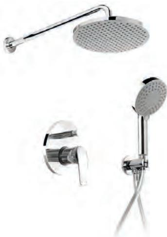
Смеситель скрытого монтажа : корпус - латунь кат. А, картридж ESKO- 35мм, переключатель помповый с фиксатором, "ушки" для монтажа, отражатель с прокладками и монтажный комплект Лейка верхнего душа: диаметр 226мм, материал - ABS пластик. Держатель верхнего душа: длина 376мм, нерж.сталь/хром. Ручная лейка: диаметр 100мм, 5 режимов, Держатель ручного душа: вертикальный, материал - латунь, хром Душевой шланг 1,6м: армированный ПВХ - серебристый, FreeRotation
