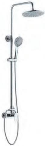
Выдвижная телескопическая стойка(нерж. сталь, хром): высота функциональная 900 -1200мм , диаметр 24мм ,вылет верхнего душа 420мм , Лейка верхнего душа(ABS) :диаметр 225мм, Ручная лейка: диаметр 110мм, 5 режимов, Смеситель латунный без излива: картридж 35мм , переключатель отдельный двухканальный (ручной душ - верхний душ), Комплектация: душевой шланг 150см (в металл. оплетке), монтажный комплект
