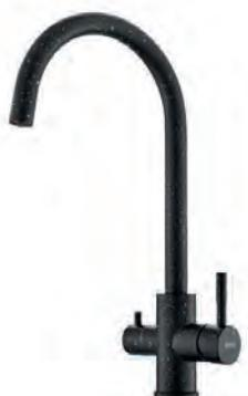
Корпус: нержавеющая сталь, марка SUS 304 (пищевая сталь),покрытие: черный матовый с гранитной крошкой, канал для фильтрованной воды. Излив: поворотный, нерж. сталь Картридж: универсальный ESKO, 35мм Комплектация: пьедестал(металл), ребро жесткости, крепление "FastFix",гибкая подводка 40см.
