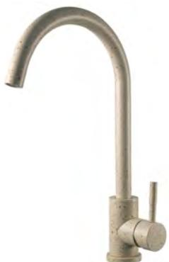
Корпус: нержавеющая сталь, марка SUS 304 (пищевая сталь), покрытие: гранит матовый бежевый. Излив: поворотный, нерж. сталь Картридж: универсальный ESKO, 35мм Комплектация: пьедестал, крепление "FastFix",гибкая подводка 40см.
