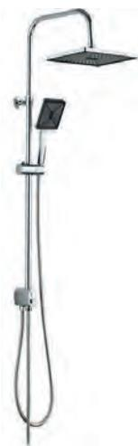
Выдвижная телескопическая стойка (нерж.сталь, хром): высота функциональная 1000 мм - 1300 мм, диаметр 22 мм, вылет верхнего душа 330 мм. Держатель лейки плавающий FightFix. Лейка верхнего душа (ABS-пластик, хром): размер 183 мм x 243 мм. Ручная лейка: размер 100 мм x 115 мм, 3 режима. Переключатель с ручного на верхний душ: кнопочный. Комплектация: душевой шланг 150 см и шланг для подкл. к смесителю (серебристый, металлический), монтажный комплект
