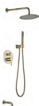
Смеситель скрытого монтажа с переключателем: корпус - латунь кат. А, картридж ESKO- 35мм, переключатель помповый с фиксатором. Лейка верхнего душа: диаметр 226мм, материал - ABS пластик/золото, Держатель верхнего душа с отводом: длина 376мм, нерж.сталь/золото. Ручная лейка: диаметр 110мм, 5 режимов. Душевой шланг 1,6м: армированный ПВХ, FreeRotation. Излив: латунь, длинна 20см, дивертор с фиксатором.
