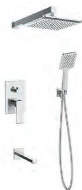
Смеситель скрытого монтажа с переключателем на 3 потребителя: корпус - латунь кат. А, картридж ESKO-35мм, переключатель механический, "IBOX" для монтажа, Лейка верхнего душа: диаметр 218мм, материал - ABS пластик, Держатель верхнего душа с отводом: вылет 377мм, нерж.сталь, кронштейн крепления и Ручная лейка: диаметр 101мм, 1 режим, Держатель ручного душа: вертикальный с поворотным держателем, материал - латунь. Излив из стены. Душевой шланг 1,5м: металл. оплетка.
