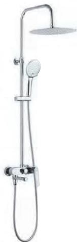
Телескопическая стойка(нерж. сталь, хром): высота функциональная 1000 -1300мм , диаметр 25мм, держатель лейки плавающий. Лейка верхнего душа(ABS): на шарнире, диаметр 300мм. Ручная лейка: диаметр 120мм, 3 режима, переключатель - кнопка, Смеситель латунный с поворотным изливом: картридж 35мм, переключатель двухканальный , встроенный в излив автоматический переключатель, излив 140мм.
