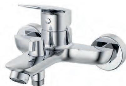
Смеситель для ванны с литым изливом. Латунный корпус. Керамический картридж 40мм. Фиксируемый дивертор не зависящий от давления воды с обратным клапаном. Увеличенный диаметр аэратора и угол наклона. В комплекте: Эксцентрики, прокладки, прямые декоративные чашки. Цвет: хром.
