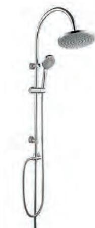
Цельная стойка(нерж. сталь, хром): высота 950мм , диаметр 25мм ,вылет верхнего душа 500мм ,держатель лейки плавающий Fight Fix, подвижное крепление Free Mount Лейка верхнего душа(нерж. сталь, хром):диаметр 226мм, + спец. клапан дополнительного аэрирования потока. Ручная лейка: диаметр 110мм, 5 режимов, Переключатель с ручного на верхний душ: керамика, в латунном корпусе Комплектация: душевой шланг 150мм и шланг для подкл. к смесителю (в метал. оплетке), монтажный комплект
