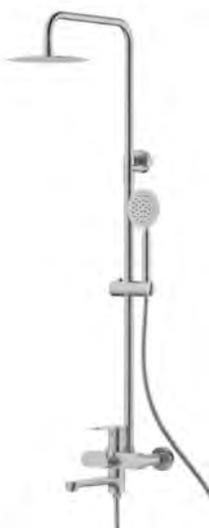
Выдвижная телескопическая стойка(нерж. сталь, покрытием (хром): держатель лейки регулируемый FightFix. Лейка верхнего душа(ABS-пластик) : на подвижном шарнире. Ручная лейка: с 3 режимами, Смеситель латунный с поворотным изливом: керамический картридж и дивертор, поворотный излив. Комплектация: душевой шланг 150см (в армированной ПВХ. оплетке) , монтажный комплект
