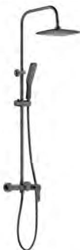
Выдвижная телескопическая стойка(нерж. сталь, черный матовый): высота функциональная 1100 -1300мм , диаметр 22мм ,вылет верхнего душа 400мм ,держатель лейки плавающий FightFix Лейка верхнего душа(ABS-пластик, матовый черный) :225X190мм, Ручная лейка: диаметр 55X245, 1 режим, Смеситель с изливом(цвет "черный матовый"): картридж ESKO 35мм , трехконтурный переключатель (излив-ручной душ - верхний душ), вылет излива 200мм , Комплектация: душевой шланг 150см
