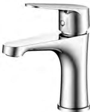
Корпус: латунь кат.А, быстросъемный аэратор Картридж: универсальный ESKO, 35мм Комплектация: крепление "две шпильки",гибкая подводка 35см.
