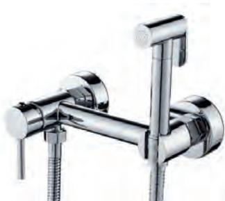
Смеситель скрытого монтажа: корпус - латунь кат. А, картридж ESKO- 25мм. Гиг. лейка: 1 режим, материал - латунь/хром, Eco system. Держатель: вертикальный, материал - латунь,хром. Душевой шланг: 120см в металл. оплетке, усиленный
