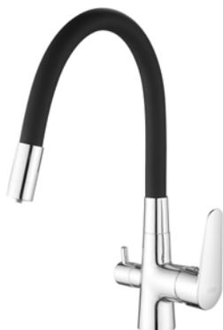
Корпус: латунь кат.А (покрытие - хром), канал для фильтрованной воды с отдельным аэратором и ручкой включения Излив: гибкий, метал. каркас, EPDM резина. Картридж: универсальный ESKO, 35мм
