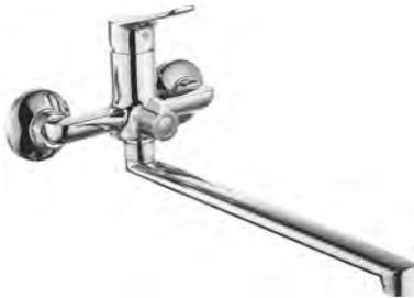
Корпус: латунь кат.А Излив: поворотный, 350мм Картридж: универсальный ESKO, 35мм Комплектация: эксцентрики, отражатели, шланг душевой нерж. 150см, лейка душевая (5 режимов), настенный держатель для лейки
