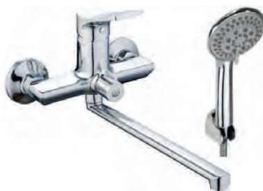
Корпус: латунь кат.А Излив: поворотный, 320мм Картридж: универсальный ESKO, 35мм Переключатель: механический(керамика) Комплектация: эксцентрики, отражатели, шланг душевой (в металл. оплетке - 150см.), лейка душевая(5 режимов), настенный держатель для лейки.
