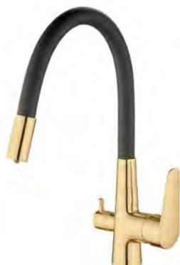
Корпус: латунь кат.А (покрытие - золото), канал для фильтрованной воды с отдельным аэратором и ручкой включения Излив: гибкий, метал. каркас, EPDM резина. Картридж: универсальный ESKO, 35мм
