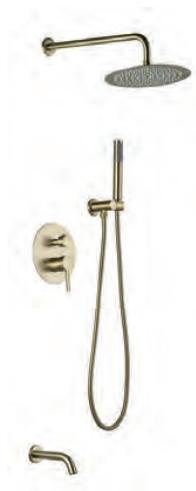
Смеситель скрытого монтажа с переключателем корпус - латунь кат. А, картридж ESKO-35мм, переключатель помповый с фиксатором. Лейка верхнего душа: диаметр 226мм, материал ABS пластик/золото, Держатель верхнего душа отводом: длина 376мм, нерж.сталь/золото. Ручка лейка: диаметр 110мм, 5 режимов. Душевой шланг 1,6м: армированный ПВХ, FreeRotation. Излив: латунь, длина 20см, дивертор с фиксатором.
