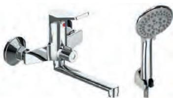
Корпус: латунь кат.А Излив: поворотный, 200 мм Картридж: универсальный ESKO, 35мм Переключатель: механический(керамика) Комплектация: эксцентрики, отражатели, шланг душевой (в металл. оплетке - 150см.), лейка душевая(5 режимов), настенный держатель для лейки.
