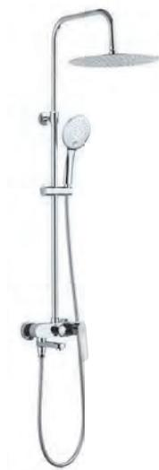
Телескопическая стойка(нерж. сталь, хром): высота функциональная 1000 -1300мм , диаметр 25мм, держатель лейки плавающий. Лейка верхнего душа(ABS): на шарнире, диаметр 300мм. Ручная лейка: диаметр 120мм, 3 режима, переключатель - кнопка, Смеситель латунный с поворотным изливом: картридж 35мм, переключатель двухканальный , встроенный в излив автоматический переключатель, излив 140мм.
