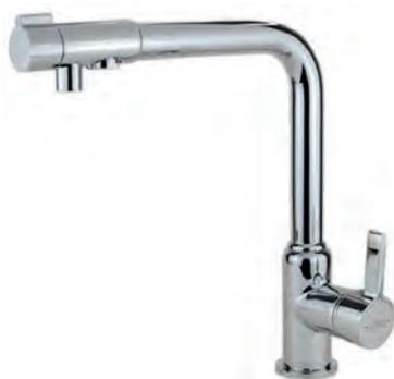
Корпус: латунь кат.А (покрытие - хром), аэратор с каналом для фильтрованной воды Излив: поворотный, нерж. сталь Картридж: универсальный ESKO, 35мм Комплектация: пьедестал(металл), ребро жесткости, крепление "FastFix",гибкая подводка 45см, шланг подключения к фильтру.
