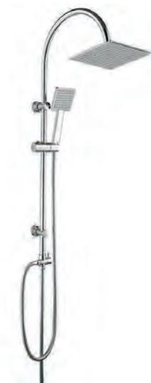
Цельная стойка (нерж. сталь, хром): высота 1000мм , диаметр 22x22мм ,вылет верхнего душа 300мм ,держатель лейки плавающий FightFix , подвижные крепления FreeMount Лейка верхнего душа(ABS) :диаметр 200мм, Ручная лейка: 1 режим, Переключатель с ручного на верхний душ: керамика Комплектация: душевой шланг 150см и шланг для подкл. к смесителю (в метал. оплетке) , монтажный комплект
