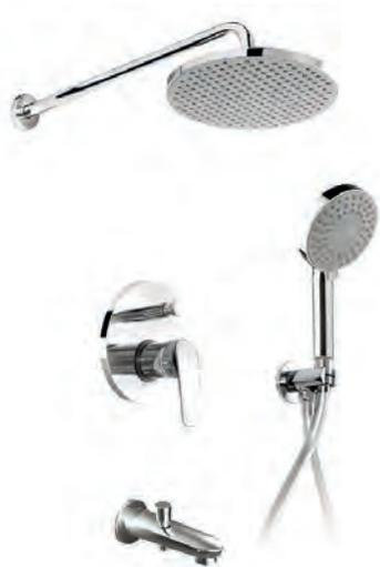
Смеситель скрытого монтажа с переключателем: корпус - латунь. Лейка верхнего душа: диаметр 226мм, материал - ABS. Ручная лейка: диаметр 90-110мм, 5 режимов. Держатель ручного душа: вертикальный, материал - ABS пластик, хром Душевой шланг 1,6м: армированный ПВХ - серебристый, FreeRotation Излив для ванны: материал - латунь, длина 20см, дивертор помповый с фиксатором, хромированный отражатель
