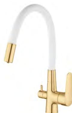
Корпус: латунь кат.А (покрытие - золото), канал для фильтрованной воды с отдельным аэратором и ручкой включения Излив: гибкий, метал. каркас, EPDM резина. Картридж: универсальный ESKO, 35мм
