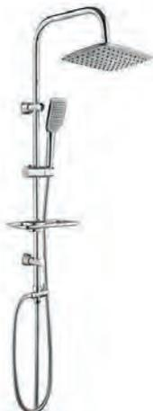
Цельная стойка (нерж. сталь, хром): высота 1000мм , диаметр 22мм ,вылет верхнего душа 300мм ,держатель лейки плавающий Fight Fix , подвижные крепления Free Mount Лейка верхнего душа(ABS-пластик, хром) :диаметр 200мм, Ручная лейка: диаметр 82мм, 3 режима, Переключатель с ручного на верхний душ: керамика, в корпусе из ABS-пластика Комплектация: душевой шланг 150см и шланг для подкл. к смесителю (в метал. оплетке) 80см., монтажный комплект
