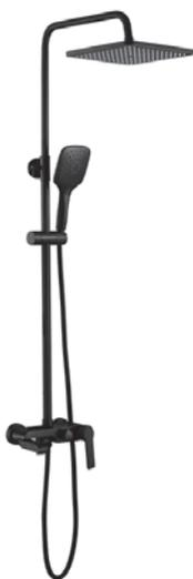
Выдвижная телескопическая стойка(нерж. сталь, покрытие "черный матовый"): высота функциональная 1020 -1570мм , диаметр 25мм ,вылет верхнего душа 369мм ,держатель лейки плавающий FightFix Лейка верхнего душа(ABS-пластик) :диаметр 225мм, Ручная лейка: диаметр 120мм с кнопчным переключением, 3 режима, Смеситель латунный с поворотным изливом: керамический картридж и дивертор, поворотный излив с вылетом 169мм служит дивертором, Комплектация: душевой шланг 150см (в мет. оплетке)
