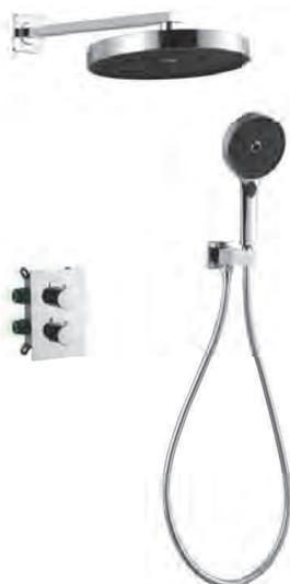
Смеситель термостатный скрытого монтажа на 2 потребителя с прогрессивным картриджем: корпус - латунь кат. А, картридж ESKO- 35мм, "IBOX" для монтажа, Лейка верхнего душа: диаметр 255мм, материал - ABS пластик, Держатель верхнего душа с отводом: вылет 383мм, нерж.сталь, кронштейн крепления и Ручная лейка: диаметр 130мм, 3 режима, Держатель ручного душа: вертикальный с поворотным держателем, материал - латунь. Душевой шланг 1,5м: армированная ПВХ оплетка.
