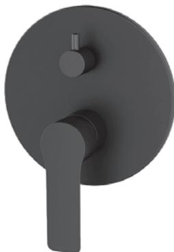
Смеситель скрытого монтажа на 2 потребителя: корпус - латунь кат. А, покрытие: черный матовый, картридж универсальный ESKO- 35мм, дивертор механический 2-ух контурный, "IBOX" для монтажа, отражатель и монтажный комплект
