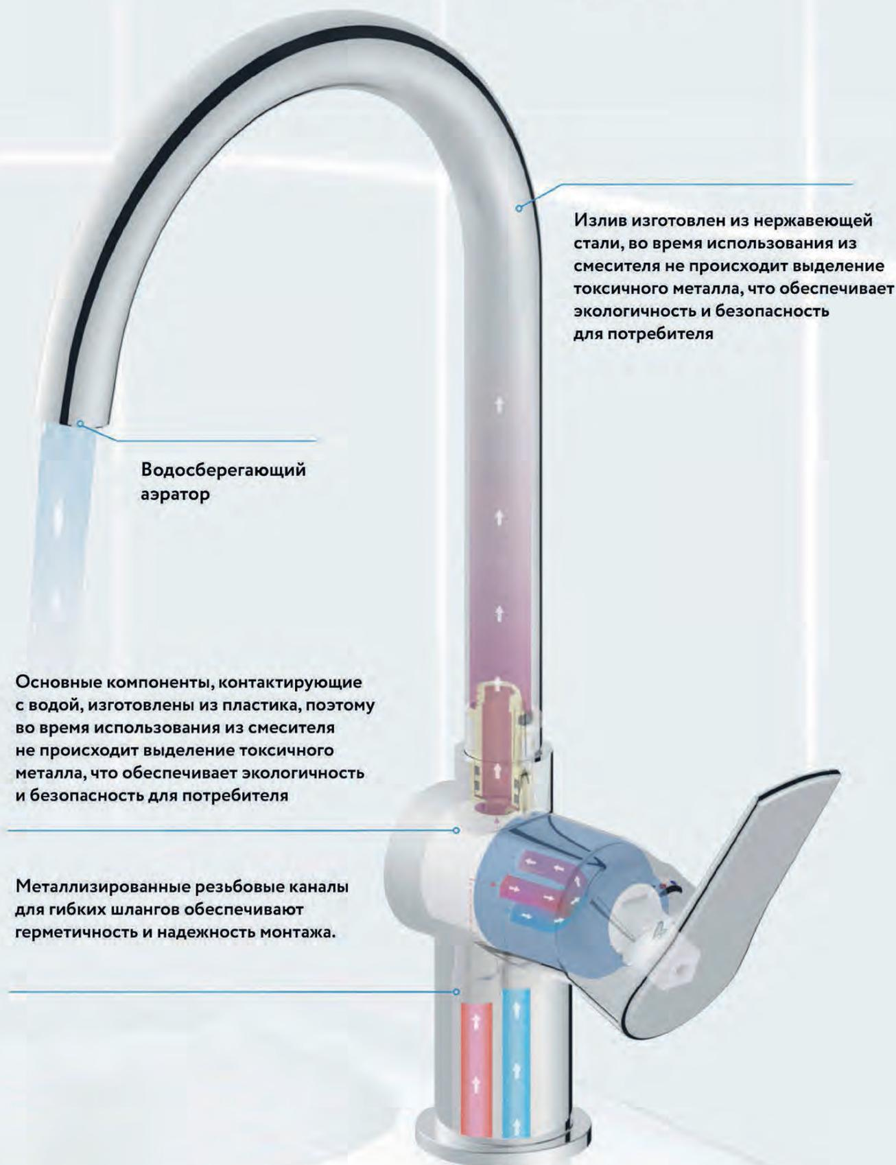
Излив изготовлен из нержавеющей стали, во время использования из смесителя не происходит выделение токсичного металла, что обеспечивает экологичность и безопасность для потребителя
