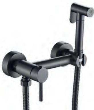
Смеситель скрытого монтажа: корпус - латунь кат. А, картридж ESKO- 25мм. Гиг. лейка: 1 режим, материал - латунь/черный, Eco system. Держатель: вертикальный, материал - латунь,черный. Душевой шланг: 120см в металл. оплетке, усиленный
