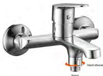
Корпус: латунь кат.А, быстросъемный аэратор Картридж: универсальный ESKO, 35мм Переключатель: помповый с фиксатором Комплектация: эксцентрики, отражатели
