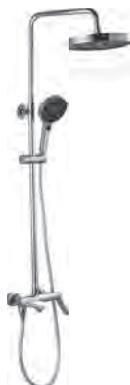
Выдвижная телескопическая стойка(нерж. сталь в хrome): высота функциональная 890 -1580мм, вылет верхнего душа 380мм , Лейка верхнего душа(ABS) :диаметр 255мм, Ручная лейка: диаметр 130мм, 3 режима,переключатель - кнопка, Смеситель с поворотным изливом: картридж 35мм , переключатель отдельный двухконтурный (ручной душ - верхний душ), выдвижной излив служит дивертором. Вылет излива 160мм, наклон аэратора 4 гр. Комплектация: душевой шланг 150см (в металл. оплетке), монтажный комплект
