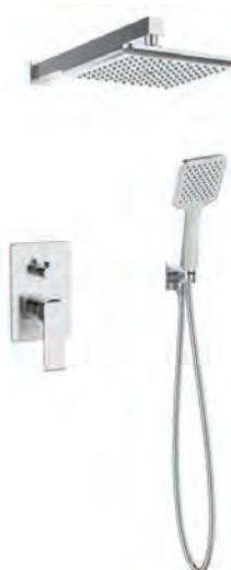
Смеситель скрытого монтажа с переключателем на 2 потребителя: корпус - латунь кат. А, картридж ESKO- 35мм, переключатель механический, "IBOX" для монтажа, Лейка верхнего душа: диаметр 218мм, материал - ABS пластик, Держатель верхнего душа с отводом: вылет 377мм, нерж.сталь, кронштейн крепления и Ручная лейка: диаметр 101мм, 1 режим, Держатель ручного душа: вертикальный с поворотным держателем, материал - латунь. Душевой шланг 1,5м: металл. оплетка.
