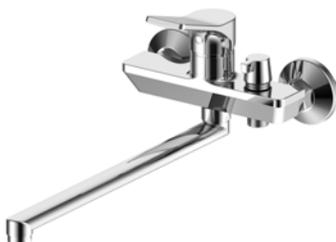
Корпус: латунь кат.А Излив: поворотный, 320мм Картридж: универсальный ESKO, 35мм Переключатель: механический(керамика) Комплектация: эксцентрики, отражатели, шланг душевой (в металл. оплетке - 150см.), лейка душевая(5 режимов), настенный держатель для лейки.
