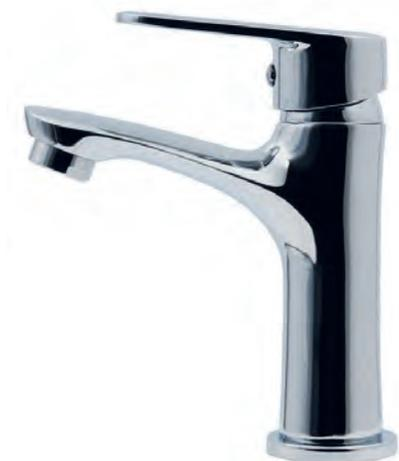
Корпус: латунь кат.А Картридж: универсальный ESKO, 35мм Комплектация: пьедестал, крепление "FastFix", гибкая подводка 40см.
