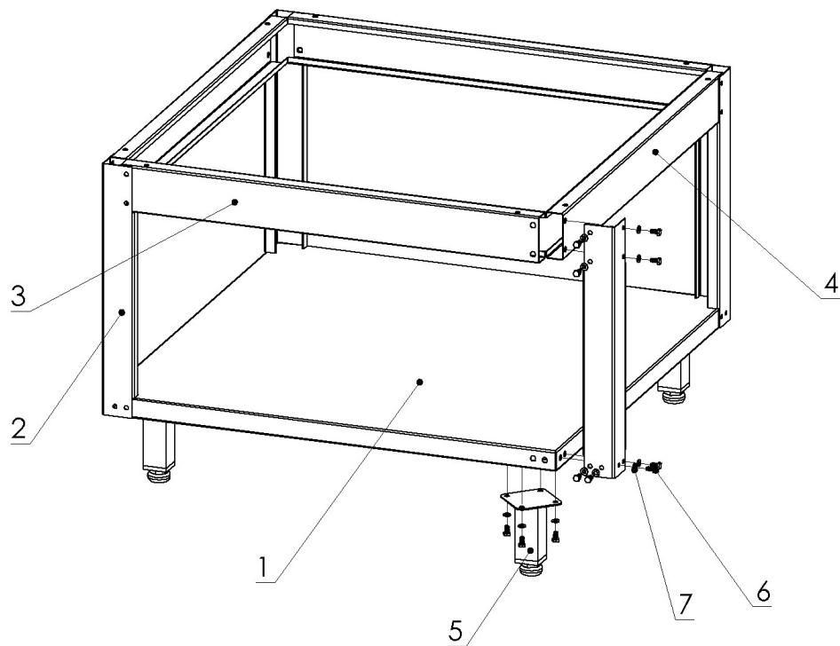
1. Ножки (поз. 5) подставки имеют пластиковые регулировочные опоры, позволяющие придать изделию устойчивое положение.
