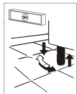
**Внимание:** Если установка оборудования не отрегулирована их функционирование и утечка конденса могут быть рискованными.
