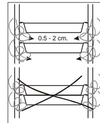
В моделях с тележками располагать структуру крепления решеток в центре камеры.
