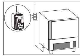
Электрическое подключение выполняется в задней части аппарата.
