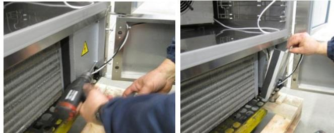
Удалить фиксирующие винты электрического щита.
