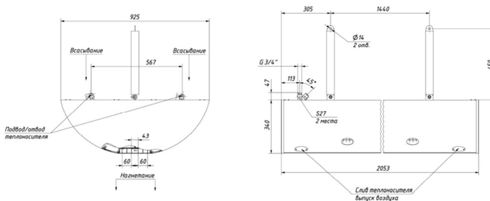
Рис. 4. Крепежные размеры КЭВ-50П6110W
