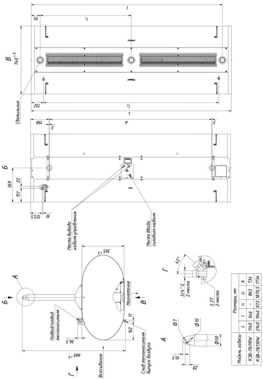
Рис. 5. Крепежные размеры КЭВ-52П6140W
