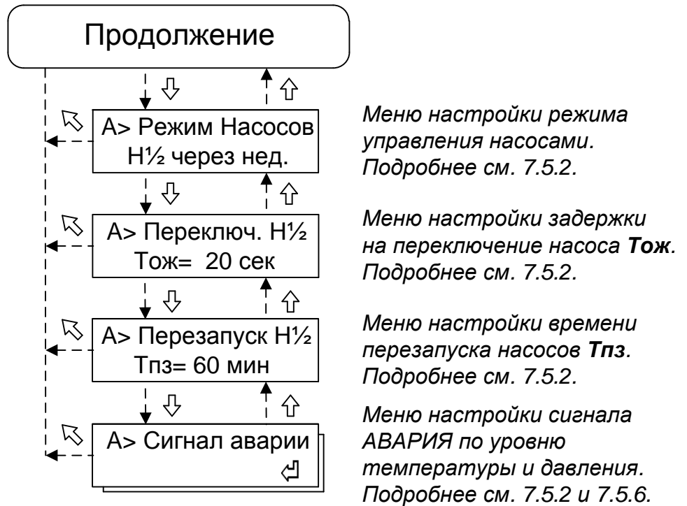
Рисунок 9 - Структура меню настройки параметров системы отопления (тип контура “СО”)
