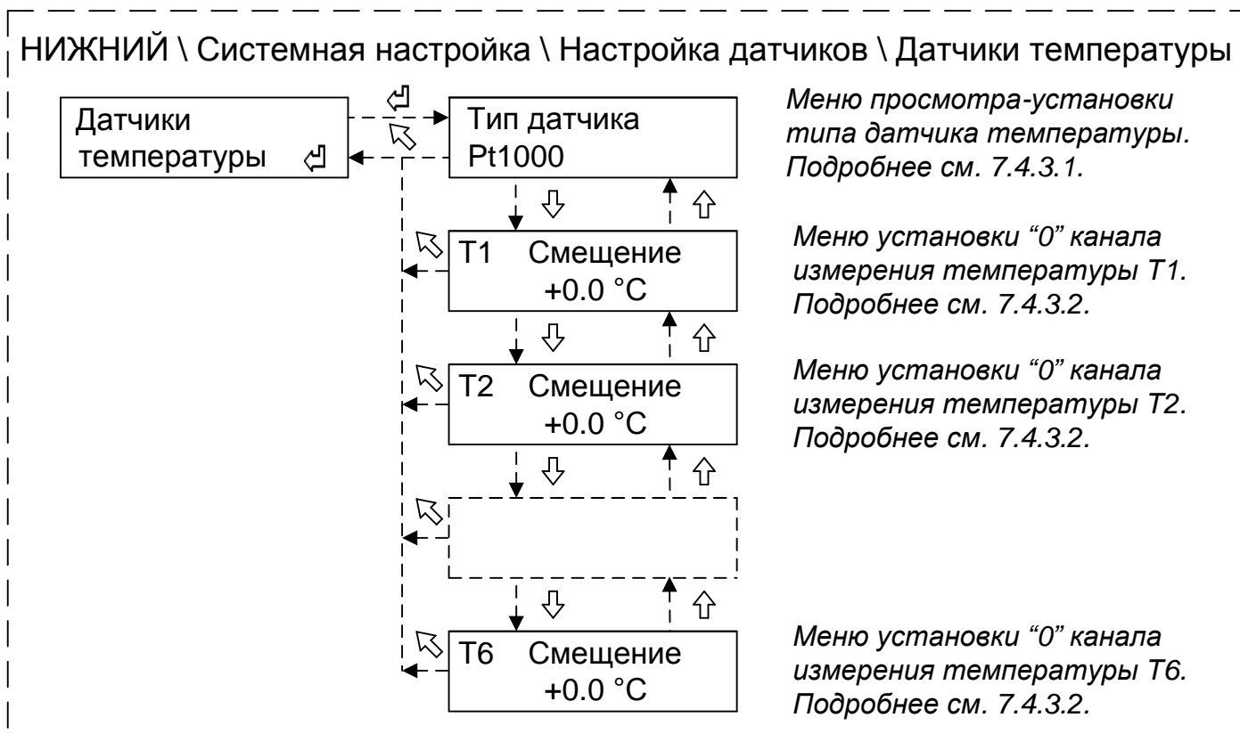
Рисунок 7 – Структура меню настройки датчиков температуры
