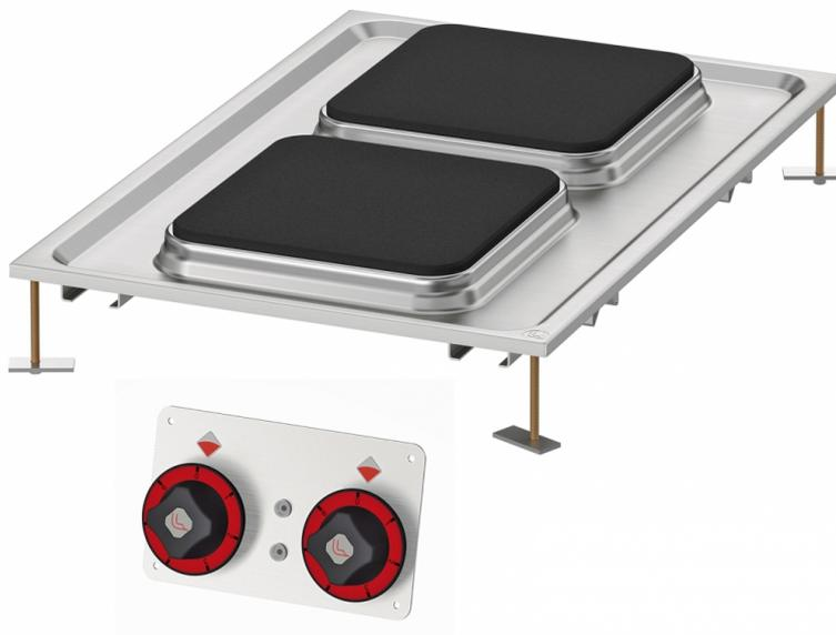
Costruzione - Modello realizzato in acciaio inox CrNi 18/10 AISI 304, con piano di spessore 2 mm, satinatura superficiale Scotch-Brite, particolari cromati. Modello - Piani di cottura elettrici e vetroceramica, per uso professionale. Piastre in ghisa di forma rotonda o quadrata, con bordo di tenuta in acciaio, commutatore a 7 posizioni e limitatore della temperatura. Piani in vetroceramica con piastre di cottura radianti e spie di segnalazione del calore residuo. Dotazioni - Staffe di fissaggio.
