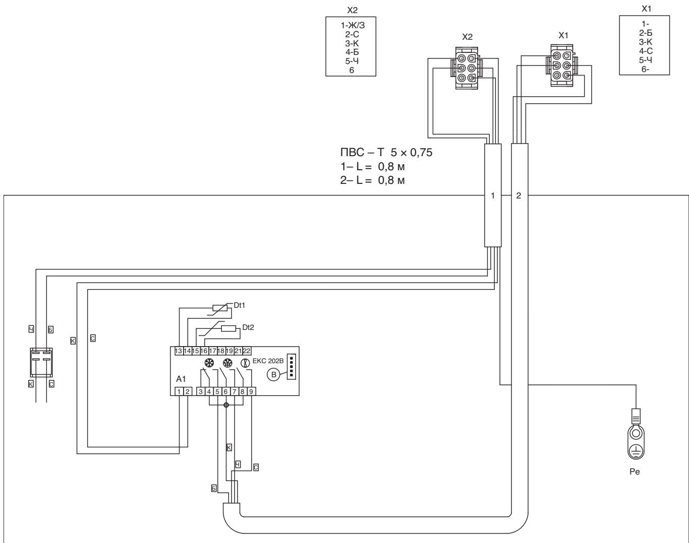
Схема электрическая монтажная холодильной витрины
