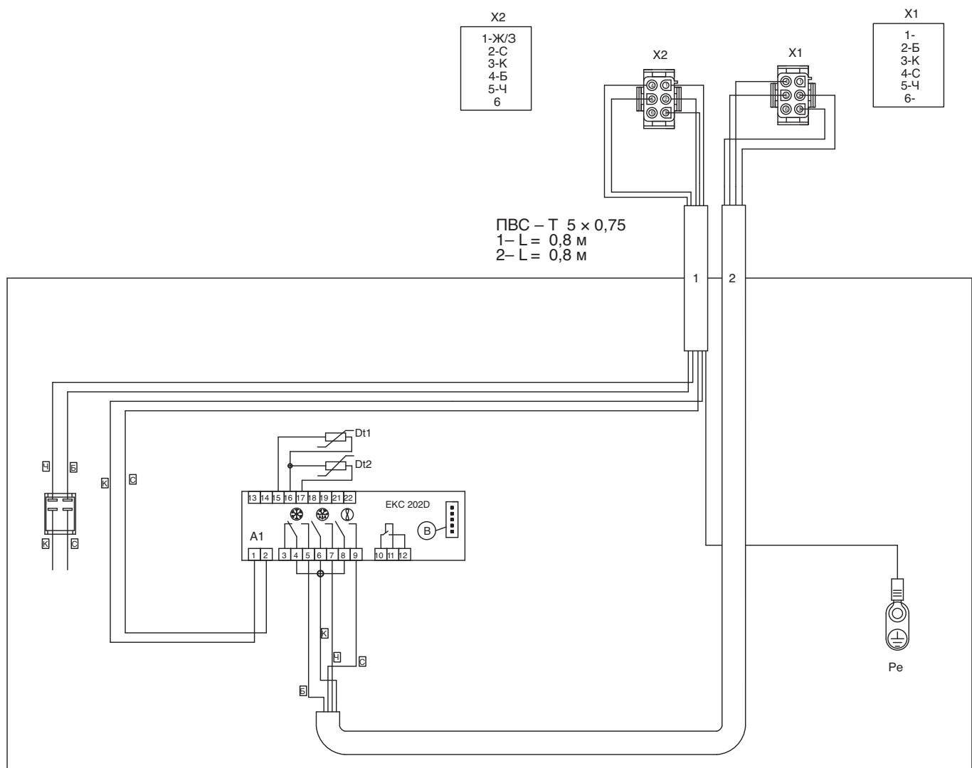
Схема электрическая монтажная холодильной витрины
