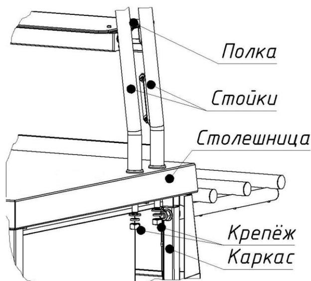
Рис.10 – Установка полки со стеклом
