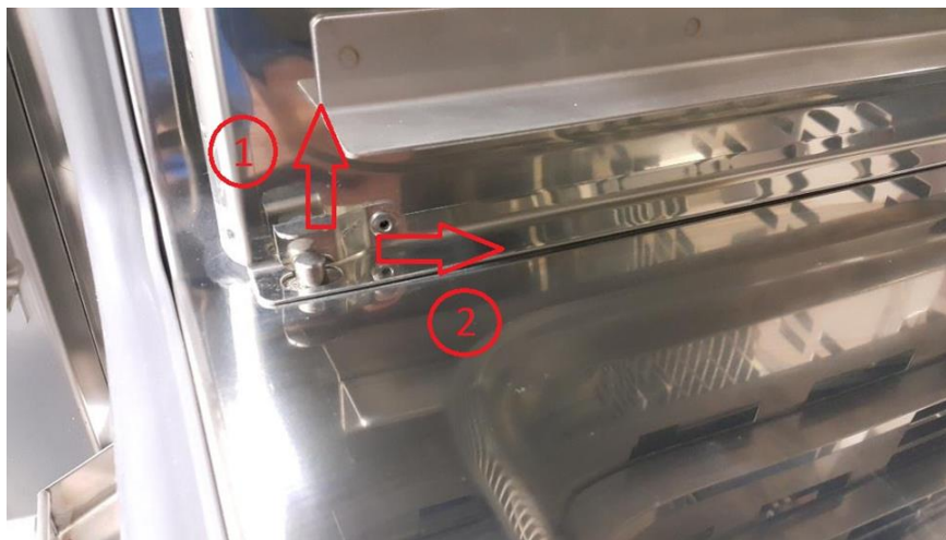
Рисунок 38: Съём держателей противней
