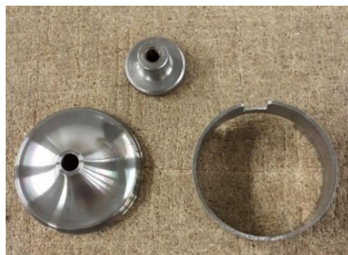
Рисунок 42: Распылительное сопло в разобранном состоянии
