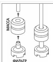
Перед тем, как вставить трубки в резервуары, закрепить на концах груз (необходимый для удержания трубки подачи на дне) и фильтр как указано на картинке. Если дозатор моющего средства не установлен изначально, его можно установить заказав соответствующий набор деталей.
