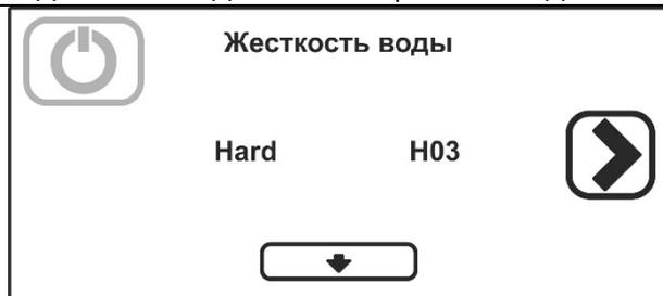
При наличии показателей свыше 60°f следует использовать наружное устройство для подготовки воды и **настроить периодичность регенерации на H00**.
