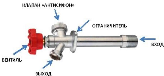
Незамерзающие краны серии WF предназначены для круглогодичного использования, в том числе и при отрицательных температурах окружающей среды. Запорная часть крана находится в пределах отапливаемого помещения, вентиль и излив – на улице, с внешней стороны здания.
