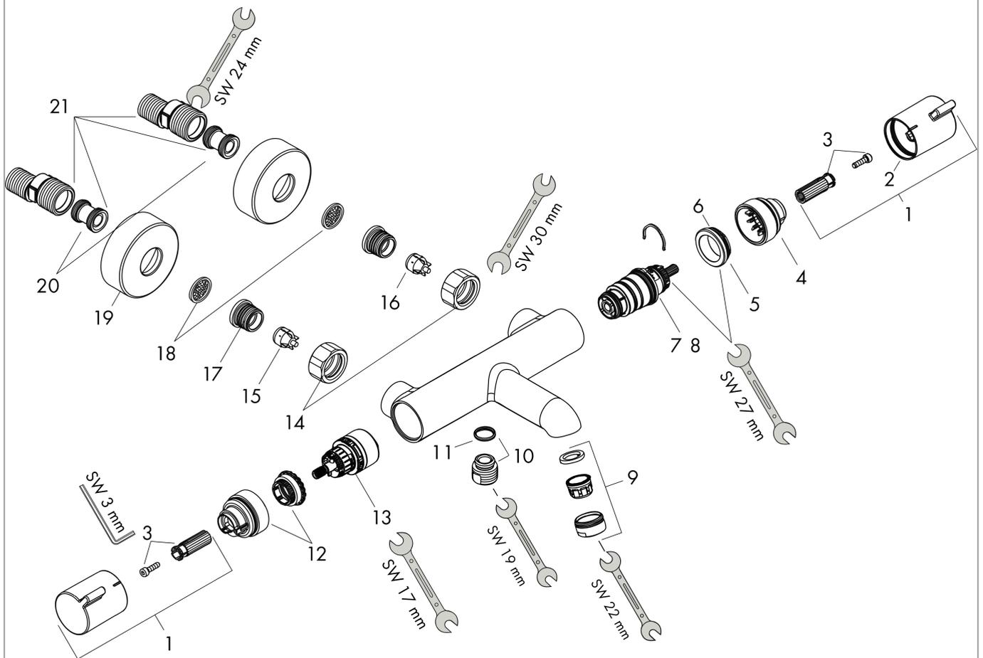
**Ecostat****Термостат для ванны Ecostat Comfort, BM, ½'**Поверхности : **шлиф. бронза** Артикульный номер: **13114140**
