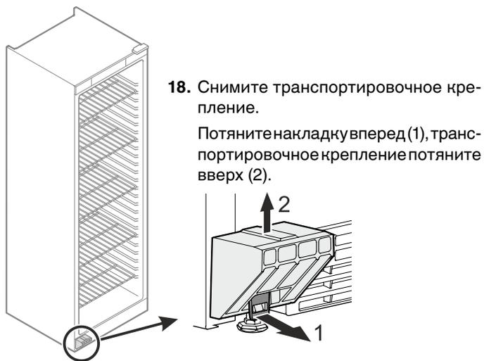
18. Снимите транспортировочное крепление.
