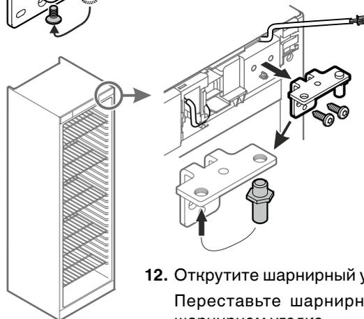
12. Открутите шарнирный уголок. Переставьте шарнирный штифт на шарнирном уголке.
