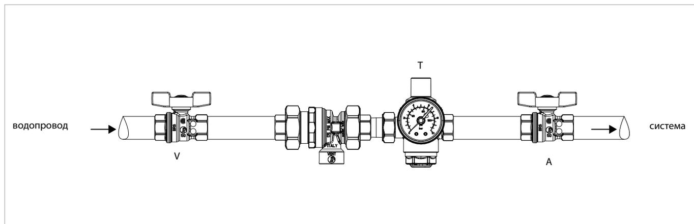
Для корректной настройки давления после наполняющего клапана необходимо установить запорный кран. Согласно выше приведённой схеме осуществить настройку клапана наполнения следуя информационному листку.
