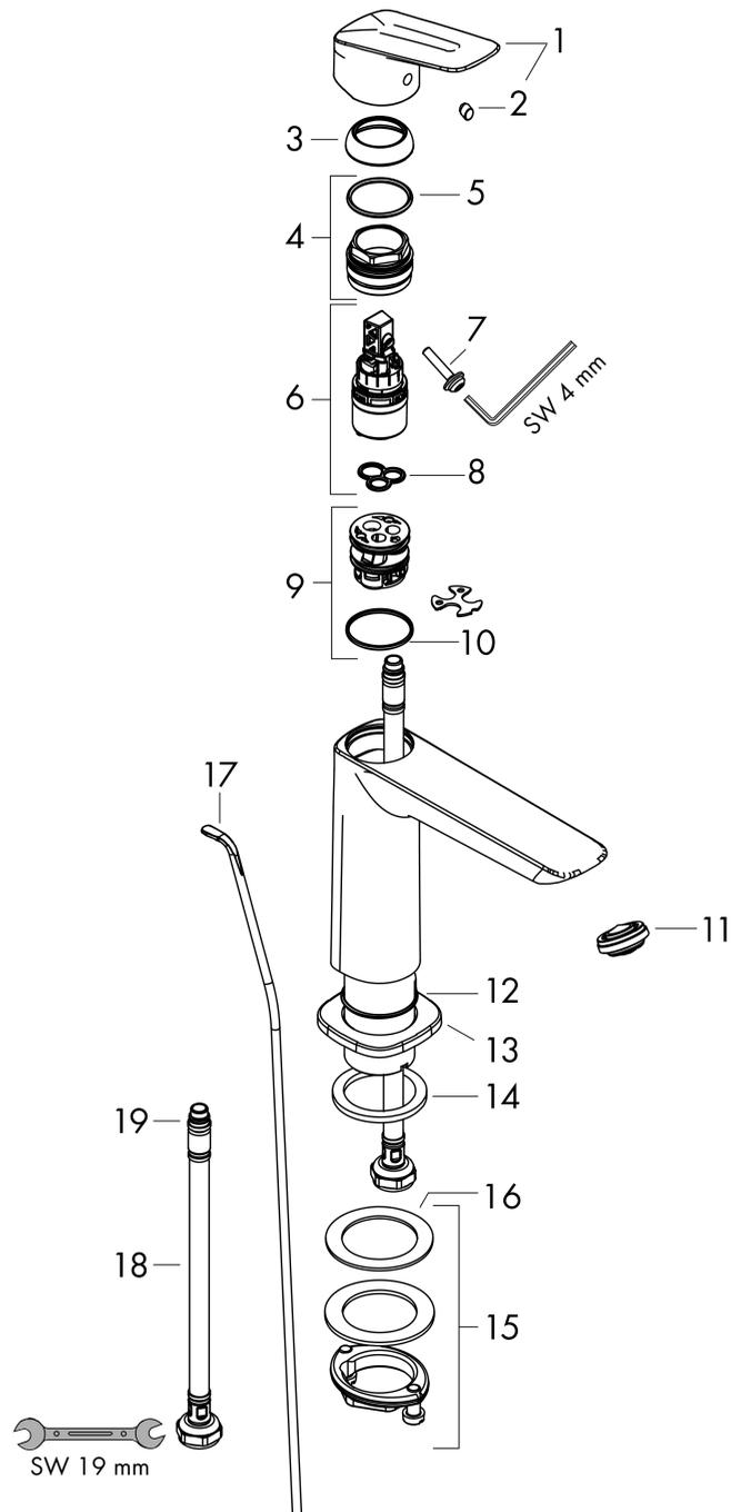
**Logis****Смеситель для раковины, однорычажный, 110 Fine, со сливным клапаном Push-Open**Поверхности : **хром** Артикульный номер: **71252000**
