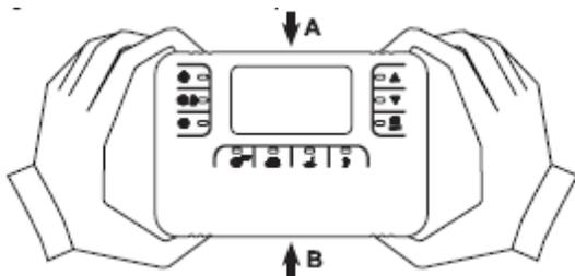
2. Соблюдая полярность, как это показано на внутренней стороне лицевой панели, вставьте два щелочных элемента питания AA LR6 1,5 В, поставляемых в комплекте с беспроводным хронотермостатом.
